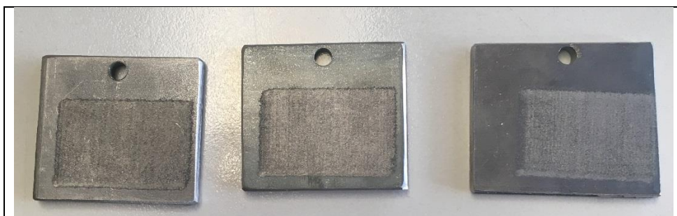
Εικόνα 16: Φωτογραφία Δειγμάτων \text{Cr}_2\text{O}_3\text{-TiO}_2\text{-C}
