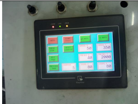
Εικόνα 9: Σύστημα ελέγχου κίνησης ηλεκτροδίου
