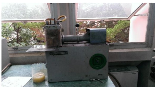
Εικόνα 11: Μηχάνημα μικροτομής δείγματος
