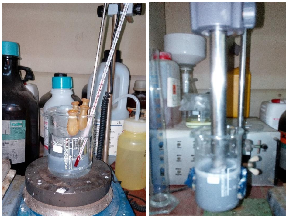
Εικ. 3.3.2. Δεξιά απεικονίζεται η σύνθεση αιωρήματος με CNTs και αριστερά η ομογενοποίησή του μέσω disperser
