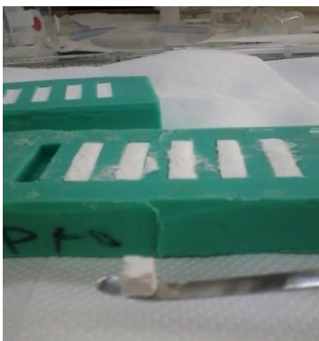
Εικ. 3.2.1. Σχηματική απεικόνιση καλουπώματος (5x5x20mm)
