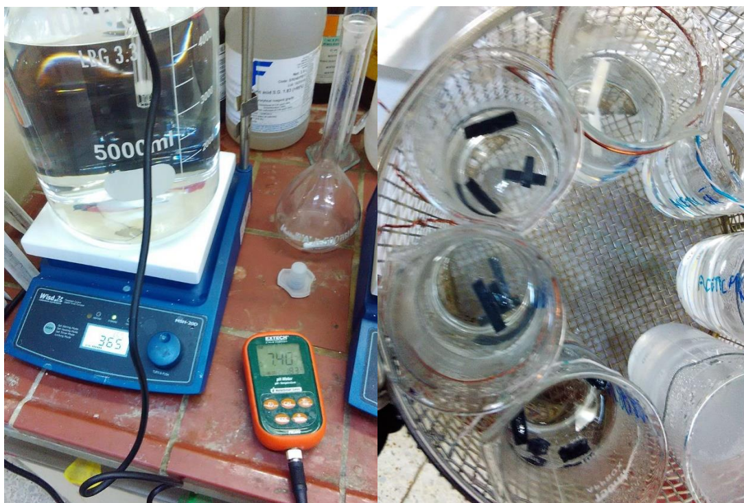
Εικ. 3.4. Δεξιά απεικονίζεται ο σταδιακός έλεγχος του pH και αριστερά η βύθιση των δοκιμίων στο διάλυμα SBF
