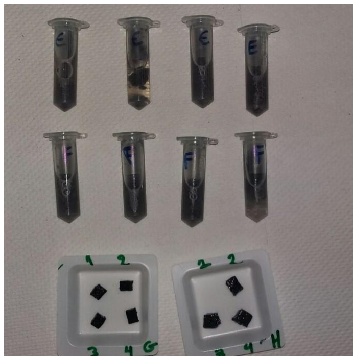
Εικ. 4.19. Σχηματική απεικόνιση διάλυσης των CCP2M1D, NCP91D, συγκριτικά με τα NCP2M2D, NCP63D που έδειξαν αυξημένη αντοχή
