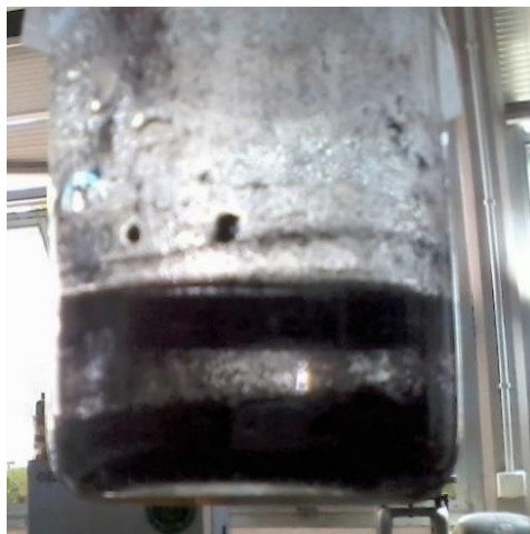
Εικ. 4.17. Σχηματική απεικόνιση μη επιτυχούς διασποράς CNTs σε πολυμερικό διάλυμα PEO
