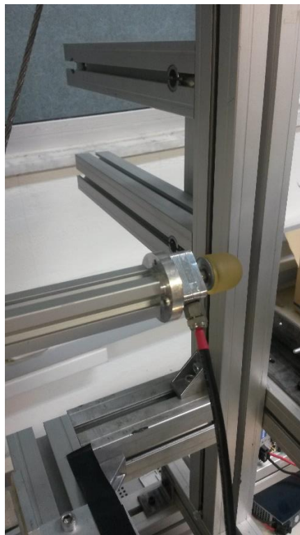
Σχήμα 5-3. Σύνδεση βραχίονα, αισθητήρα δύναμης και επικρουστήρα.
