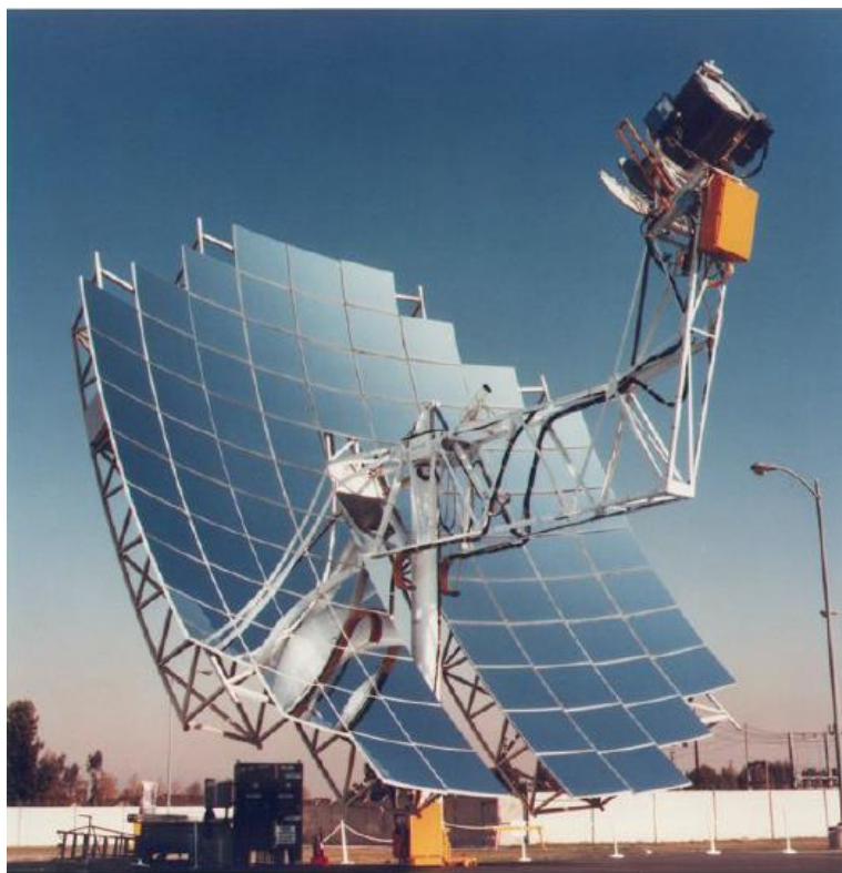
Σχήμα 42: Διάταξη ηλιακού συλλέκτη πολλαπλών κατόπτρων με μηχανή Stirling [6]
