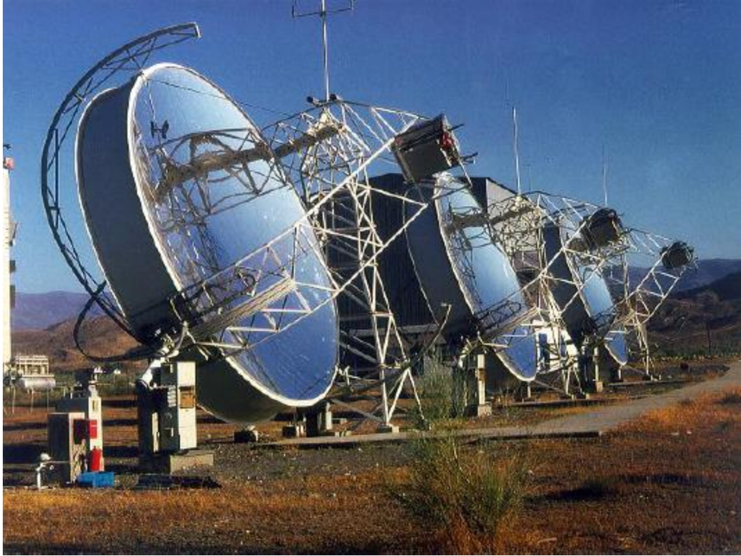
Σχήμα 40: Διάταξη ηλιακού συλλέκτη μονού κατόπτρου με μηχανή Stirling [6]
