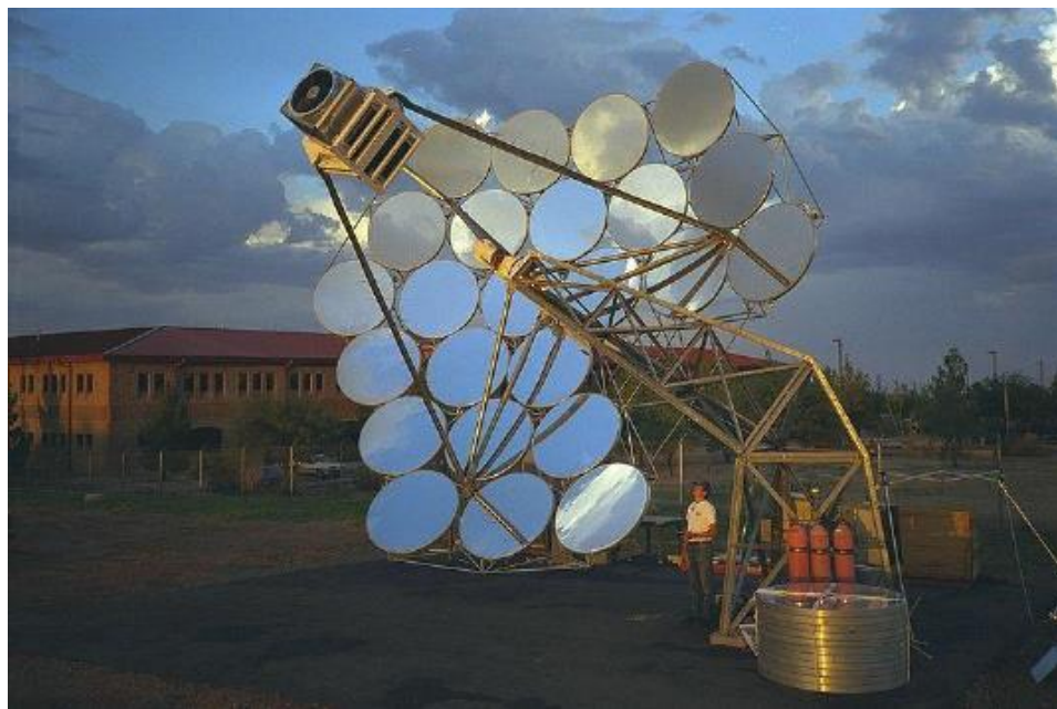
Σχήμα 41: Διάταξη ηλιακού συλλέκτη πολλαπλών κατόπτρων με μηχανή Stirling [6]
