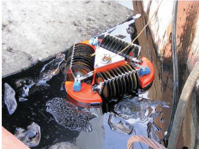
Εικόνα 3.2. Λειτουργία ξαφριστή τύπου τυμπάνου ανάμεσα από το πλοίο και ένα παγόβουνο.
