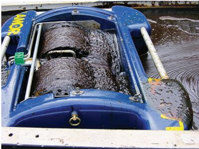
Εικόνα 3.3. Ξαφριστής τύπου βούρτσας για ανάκτηση βαριών κλασμάτων πετρελαίου.
