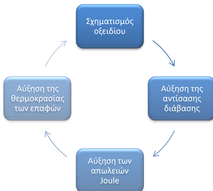
Σχήμα 1.2-1: Απλοποιημένη παράσταση της επίδρασης της θερμοκρασίας στη δημιουργία οξειδίων
