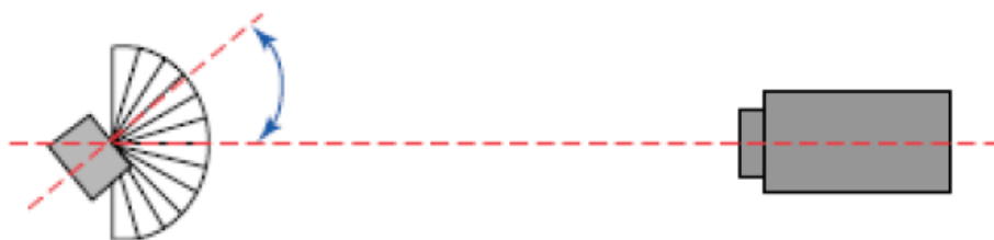
Σχήμα 1.8.3.4-2: Περιστροφή του κύβου Leslie για τη μέτρηση της εκπεμπτικότητας συναρτήσει της οπτικής γωνίας με σημείο αναφοράς την κάμερα
