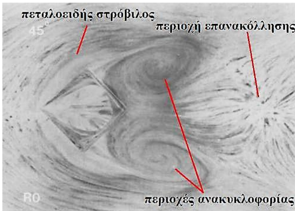
Σχήμα 3.10: Κάτοψη σχηματιζόμενης ροής από έλαιο [50]
