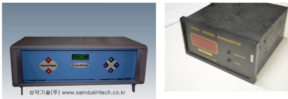
Σχήμα 4.30: Αριστερά ο σαρωτής πίεσης FCS421 [87] και δεξιά το διαφορικό μανόμετρο FCO16 [37]
