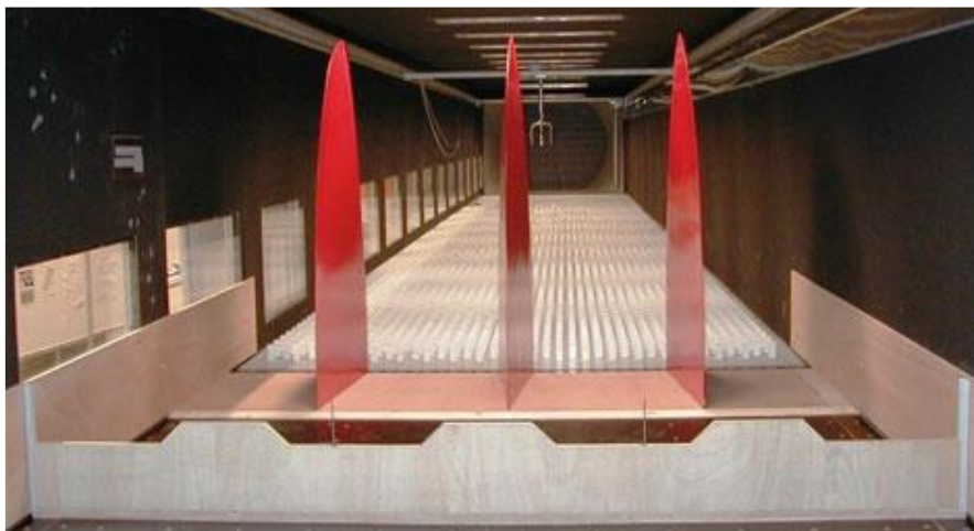
Σχήμα 4.5: Πειραματική διάταξη προσομοίωσης οριακού στρώματος κατά Counihan [78]
