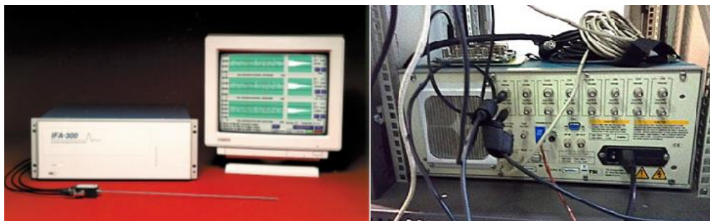
Σχήμα 4.18: Διάταξη συσκευής θερμού νήματος IFA300 [86] και πίσω όψη της συσκευής IFA300
