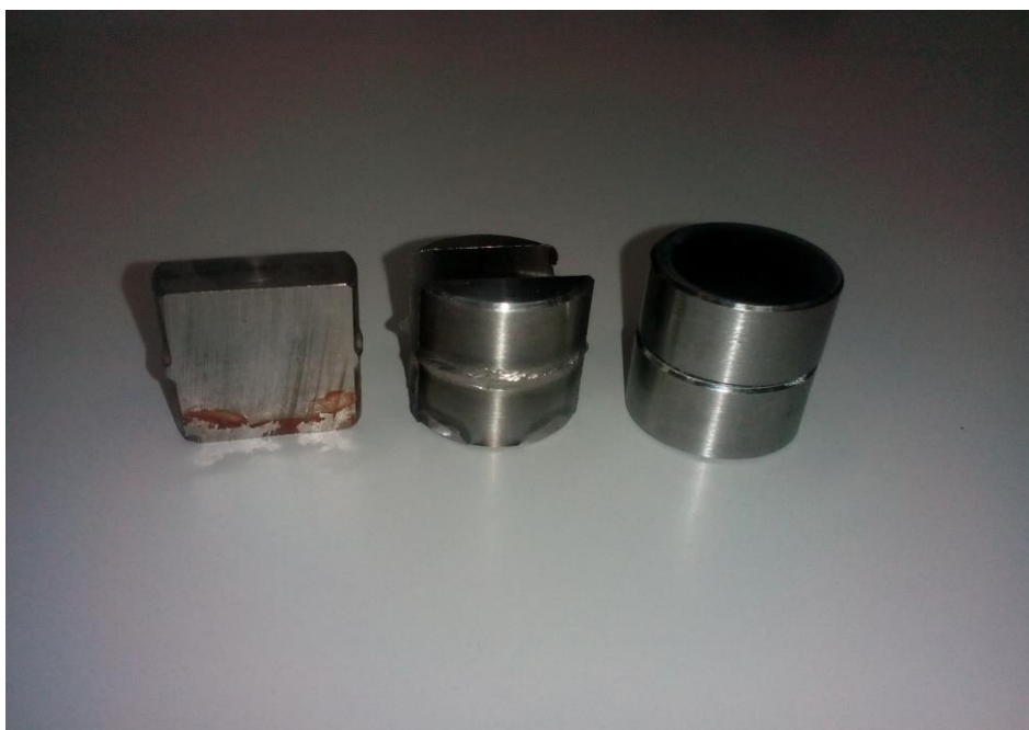
Διάγραμμα 3.4 – Απεικόνιση επιμέρους τεμαχίων του συγκολλημένου δοκιμίου, εκ των οποίων το αριστερό δοκίμιο υπέστη διάβρωση με έκθεση σε αλατονέφωση, κάθετη τομή
