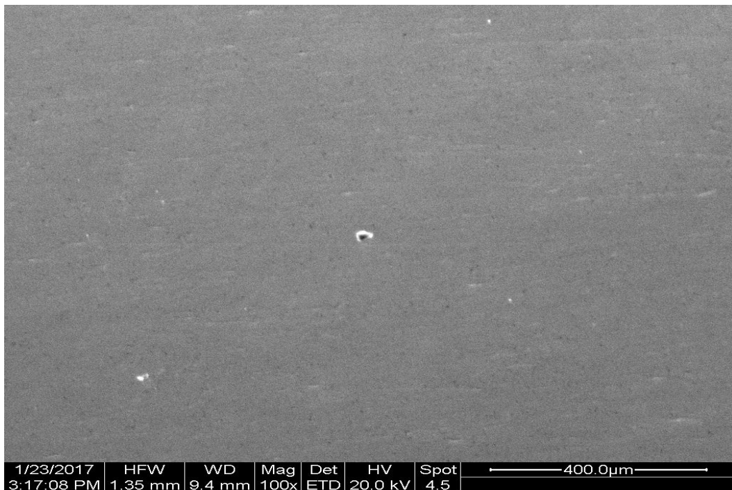
Σχήμα 3.21 – Μικρογραφία SEM της λείας επιφάνειας του χάλυβα 15-5PH, διαβρωμένου με έκθεση σε αλατονέφωση, κάτοψη
