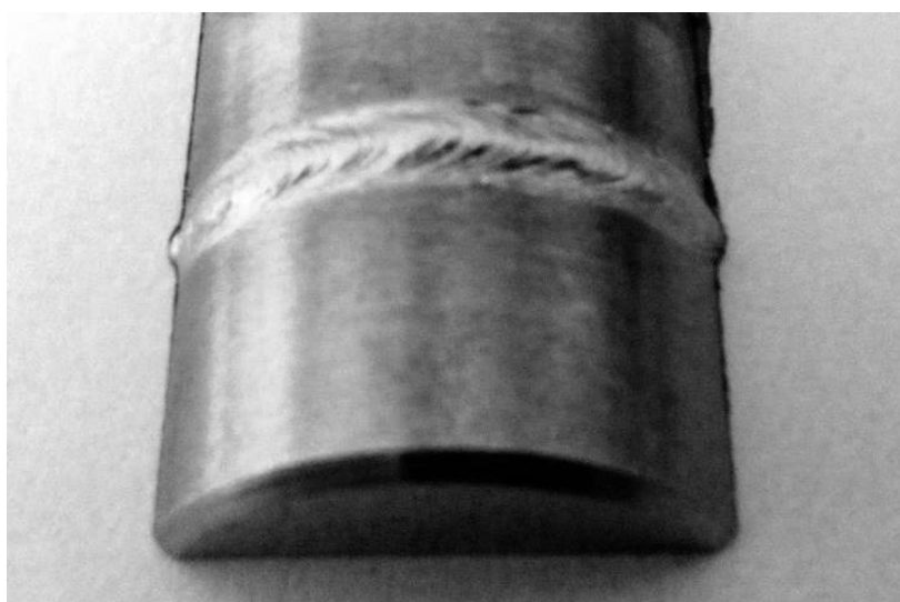
Σχήμα 2.2 – Περιφερειακή συγκόλληση όμοιων κυλινδρικών δοκιμίων χάλυβα 15-5PH, πλάγια όψη
