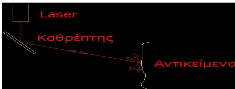
**Εικόνα 8 :** Αρχή λειτουργίας της Time of flight τεχνικής τρισδιάστατης ανίχνευσης [40]
