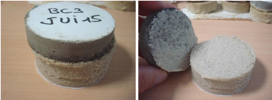
Figure 31 : Bicouche sable-béton après cisaillement.
