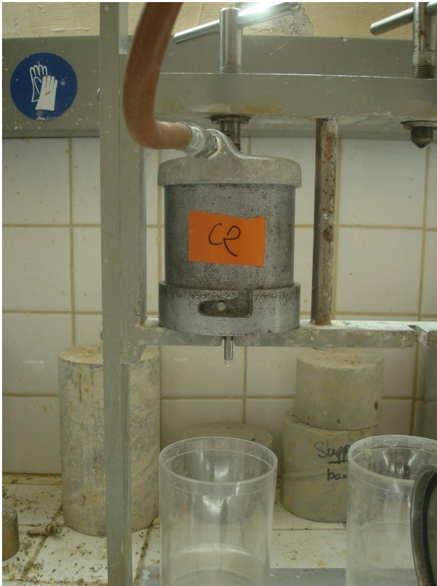
Figure 1 : Cellule API avec la trousse coupante à l'intérieur et le sable saturé (droite) et cellule sur le bâti de mise pression (gauche).
