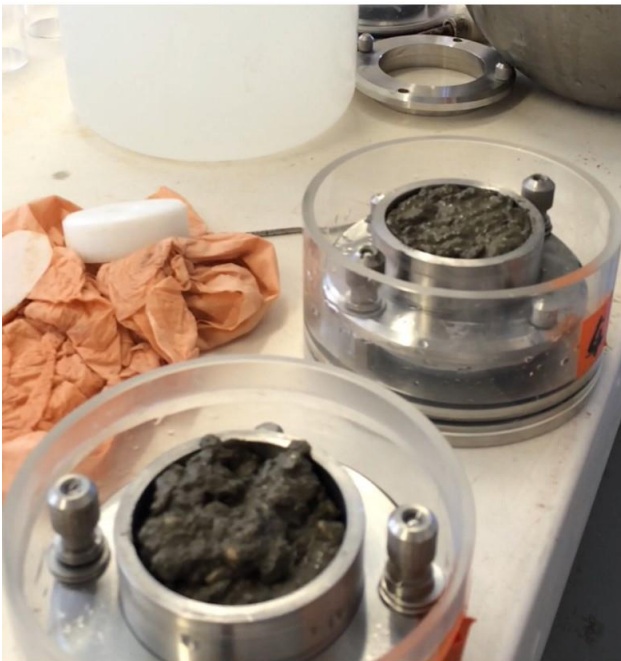
Figure 2 : Mise en place du béton après la filtration (gauche) et consolidation du tricouche dans la cellule œdométrique (droite).
