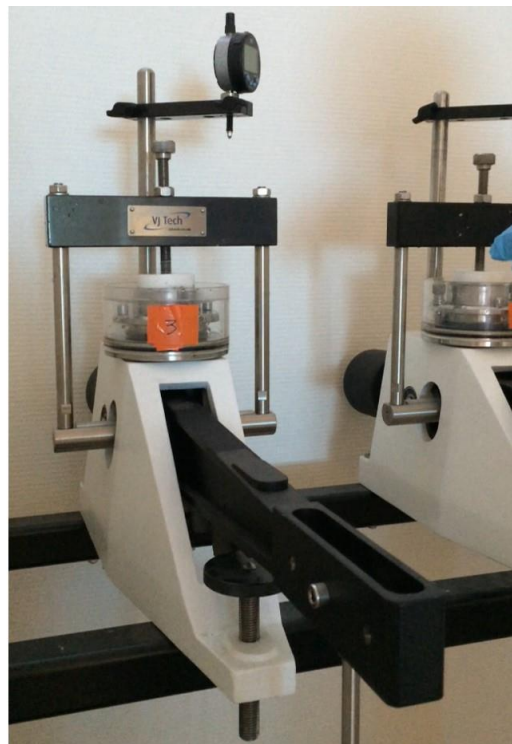
Figure 2 : Mise en place du béton après la filtration (gauche) et consolidation du tricouche dans la cellule œdométrique (droite).
