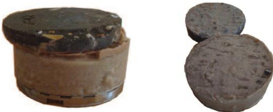
Figure 34 : Tricouche sol-bentonite-béton après cisaillement.
