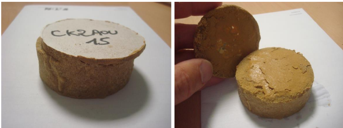
Figure 32 : Cake de bentonite CM10T pure après cisaillement.
