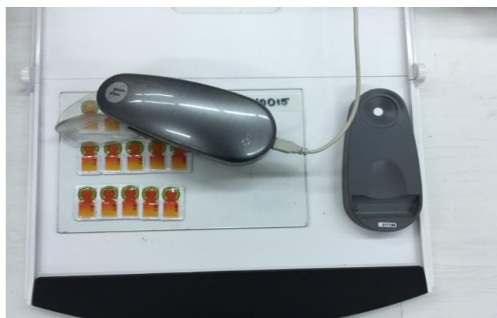
Εικόνα 4.5-Χρωματόμετρο X-rite Eye1pro
