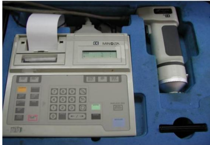
Εικόνα 4.16-Χρωματόμετρο Minolta CR-200(Minolta Company, Chuo-Ku, Osaka, Japan)
