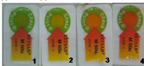
Εικόνα 3.3-Χρωματική κλίμακα τρίχρωμου Vitsab TTI μετά την ενεργοποίηση(πράσινο→ κίτρινο →πορτοκαλί)
