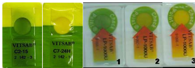
Εικόνα 3.2- Χρωματική κλίμακα του δίχρωμου Vitsab TTI μετά την ενεργοποίηση (πράσινο→κίτρινο)
