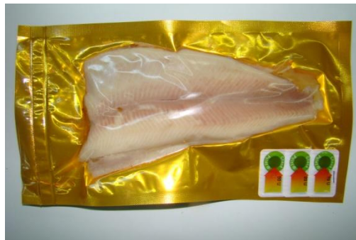
Εικόνα 4.10- Συσκευασία φιλέτου καπνιστής πέστροφας συσκευασμένου υπό κενό μετά την τοποθέτηση ενζυμικών ΤΤΙ τύπου LP
