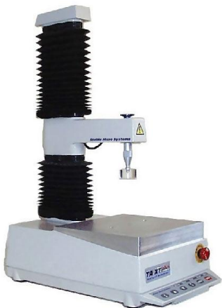
Εικόνα 4.17-Αναλυτής υφής TA-XT2i Texture Analyzer
