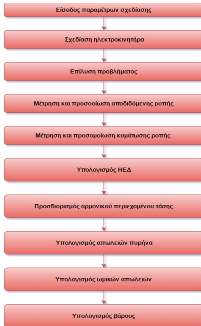
Σχήμα 5.3 Διάγραμμα διεργασιών για τον υπολογισμό των ηλεκτρομαγνητικών χαρακτηριστικών των κινητήρων
