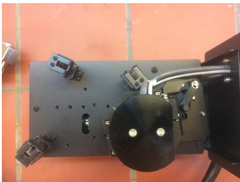
Εικόνα 4.2 Η σφαίρα ολοκλήρωσης που χρησιμοποιήθηκε στο πείραμα
