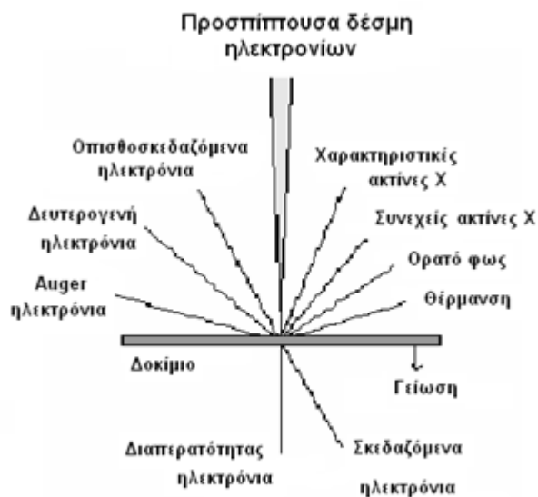
Εικόνα 4.6 Φαινόμενα αλληλεπίδρασης δέσμης - δείγματος
