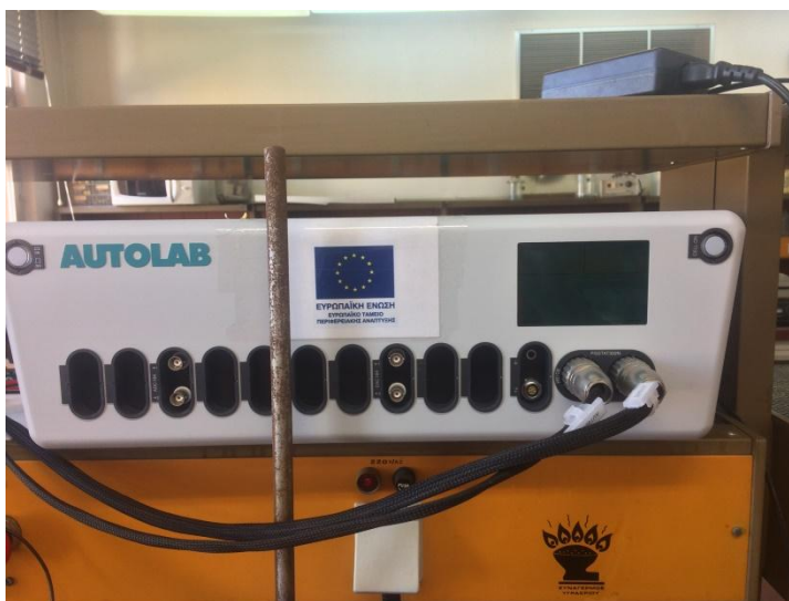
Εικόνα 5.4 Ποτενσιοστάτης Metrohm Autolab PGSTAT302N
