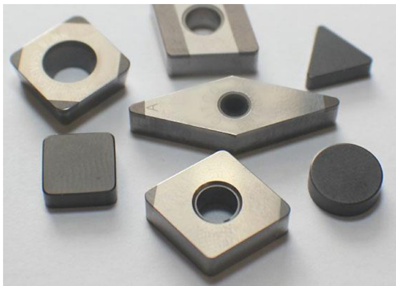
Εικόνα 2.2: Κοπτικά εργαλεία από πολυκρυσταλλικό κυβικό βοριοιτρίτη ( http://www.secotools.com/pcbn )
