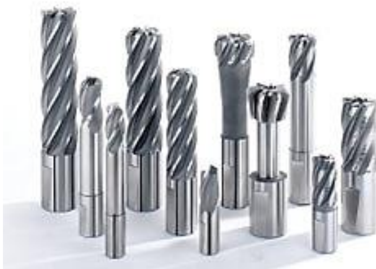
Εικόνα 2.1: Σύγχρονα κοπτικά εργαλεία από ταχυχάλυβα
