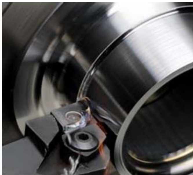
Εικόνα 2.8: Ενθέματα PCBN σε εργαλείο τόννευσης (PCBN guide)
