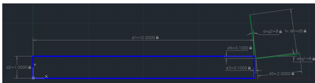
Εικόνα 3.2 : Δισδιάστατη γεωμετρία τεμαχίου και κοπτικού εργαλείου (βάθος κοπής 0.1 mm) στο Autodesk
