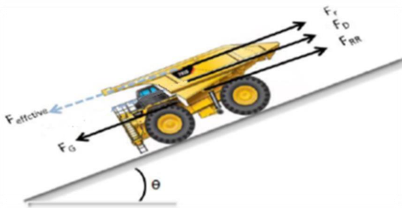
Εικόνα 5. Οι αναπτυσσόμενες δυνάμεις παράλληλα προς το επίπεδο κίνησης του φορτηγού σε κατηφορική οδό (Parreira, 2013).
