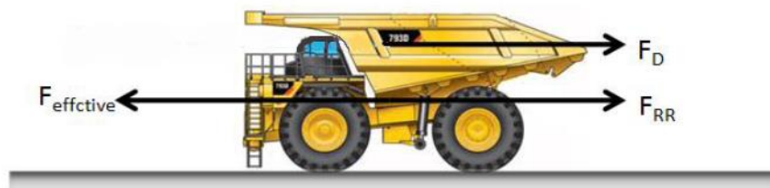
Εικόνα 3. Οι αναπτυσσόμενες δυνάμεις παράλληλα προς το επίπεδο κίνησης του φορτηγού σε οριζόντια οδό μεταφοράς (Parreira, 2013).
