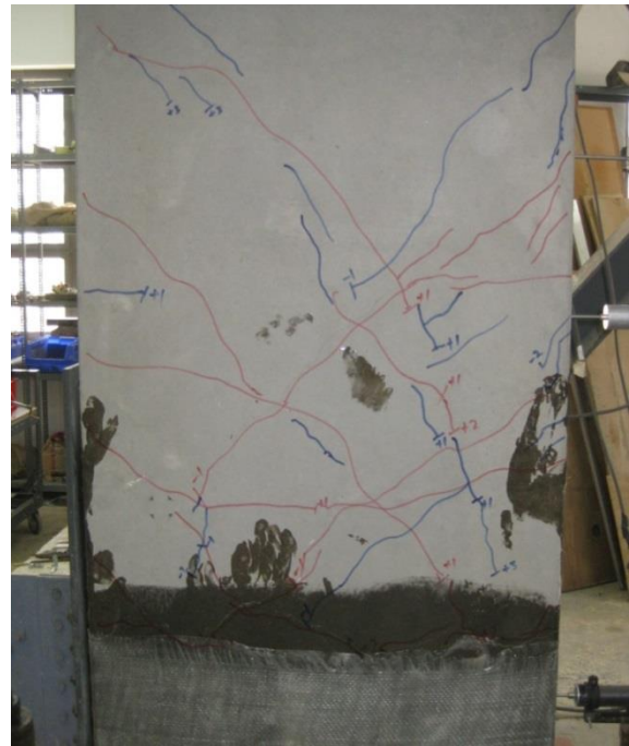
(β) Ρωγμές στους κύκλους των \pm 20\text{mm}
