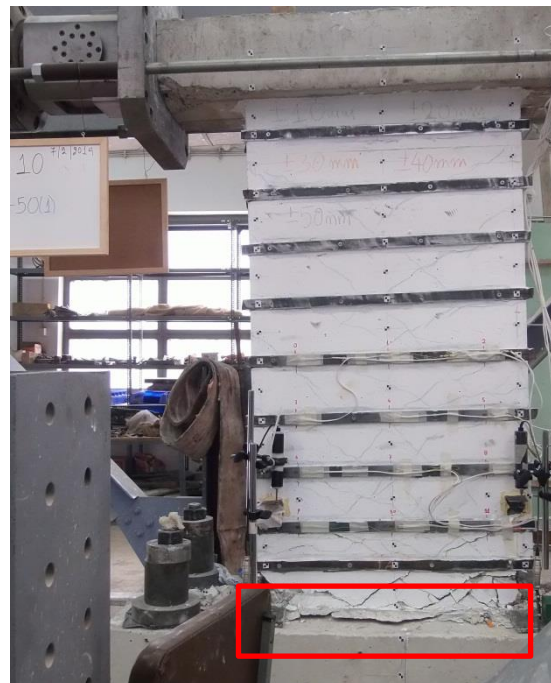
(β) Ρωγμές στον 1 ο κύκλο -50mm
