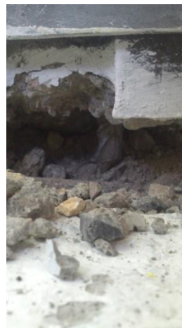
(β) Θραύση εφελκόμενου οπλισμού για μετακίνηση +50mm
