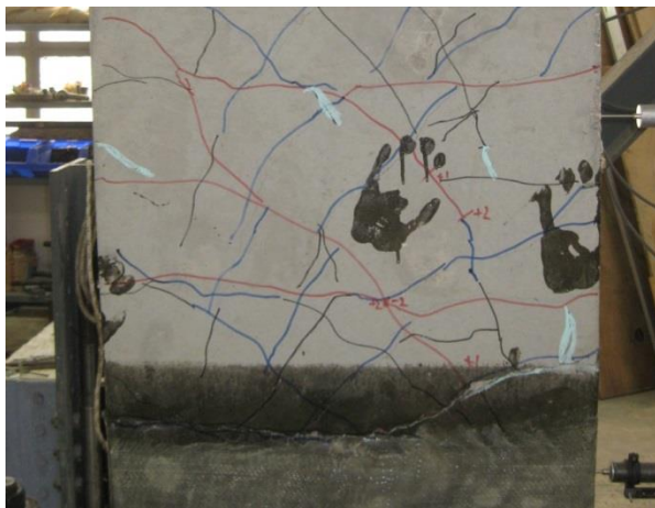
(α) Ρωγμές στους κύκλους των \pm 40\text{mm}
