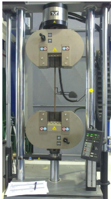
Σχήμα 3.10 Δοκιμή σε μονοαξονικό εφελκυσμό ράβδου οπλισμού.
