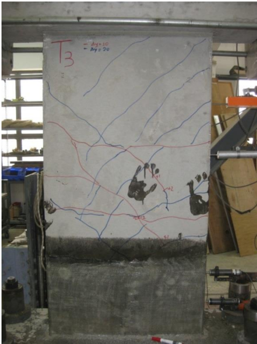
(α) Ρωγμές στους κύκλους των \pm 20\text{mm}
