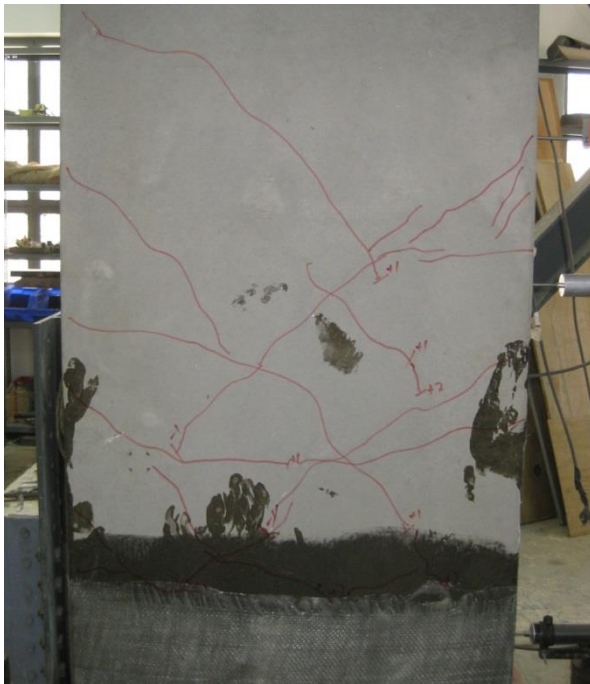
(α) Ρωγμές στους κύκλους των \pm 10\text{mm}
