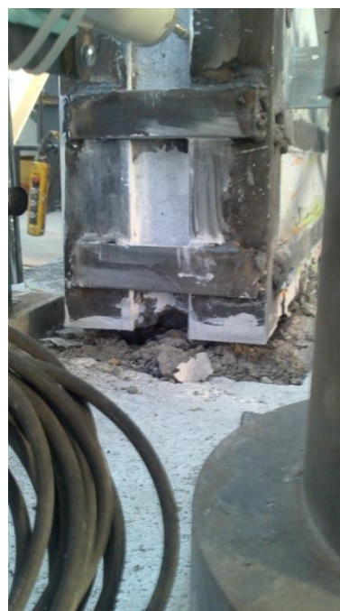
(β) Ανασήκωμα και αποδιοργάνωση βάσης δοκιμίου για μετακίνηση +50mm
