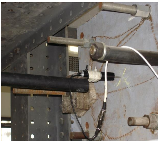
(ε) Μέτρηση μετατόπισης του πλαισίου επενεργητή
