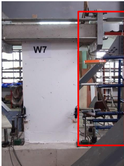
(α) Τοποθέτηση βελομέτρων καθ' ύψος
