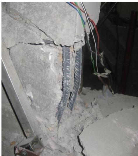
Σχήμα 4.29 Λυγισμός θλιβόμενων ράβδων δοκιμίου W_6
