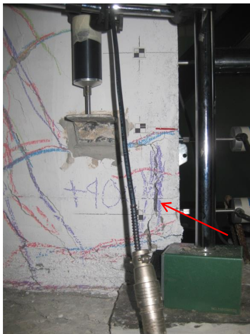
(α) Έναρξη αποφλοίωσης στον 1 ο κύκλο των +40\text{mm}
