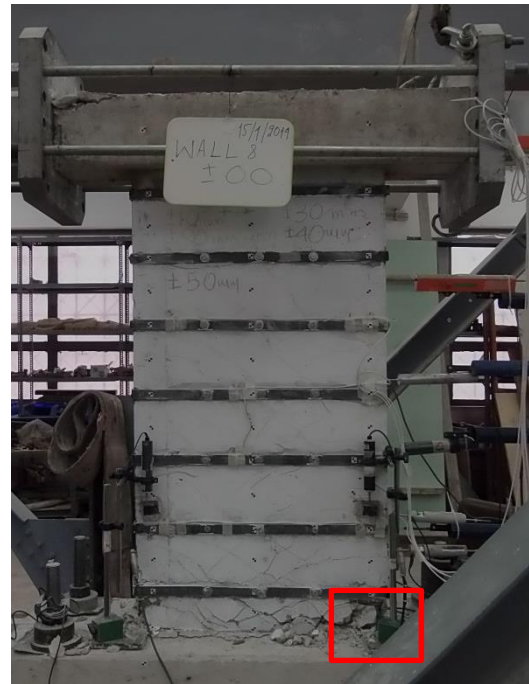
(β) Ρωγμές μετά το τέλος των μετακινήσεων \pm 50\text{mm}
