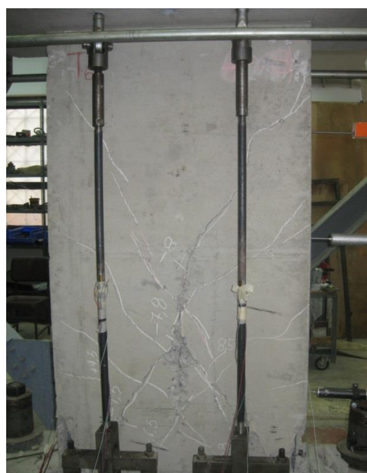
(β) Ρωγμές μετά το τέλος των \pm 20\text{mm}
