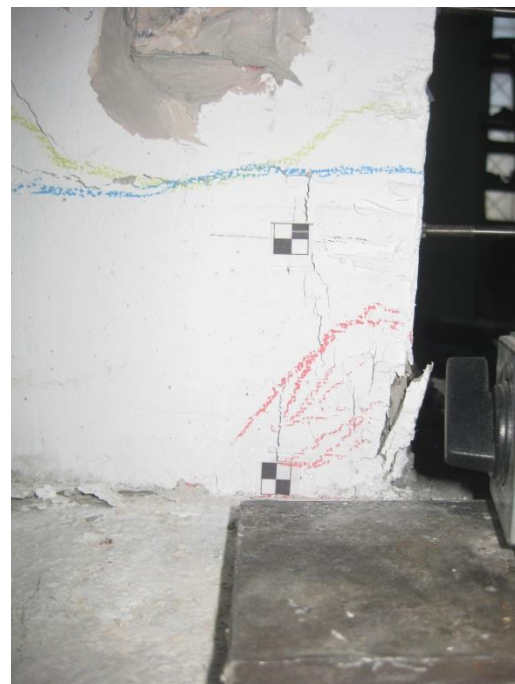
(β) Αποφλοίωση επικάλυψης για μετακίνηση +30\text{mm}
