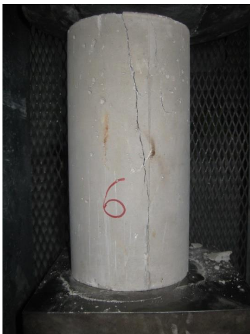
(α) Μονοαξονική θλίψη κυλινδρικού δοκιμίου
