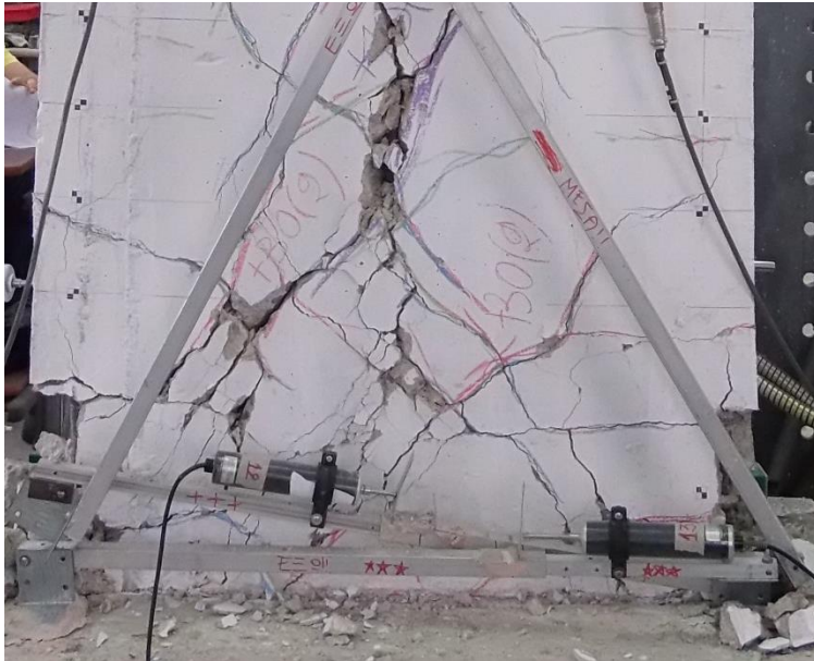
(α) Κύριες χιαστί ρωγμές κορμού (πίσω όψη)
