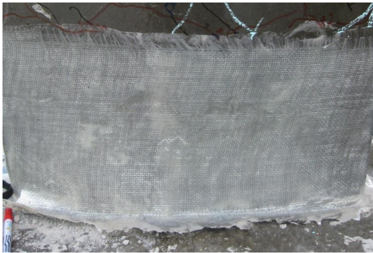
(α) Ρωγμές στους κύκλους των \pm 30\text{mm}
