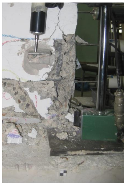
(β) Λυγισμός θλιβόμενης ράβδου για μετακίνηση +40mm
