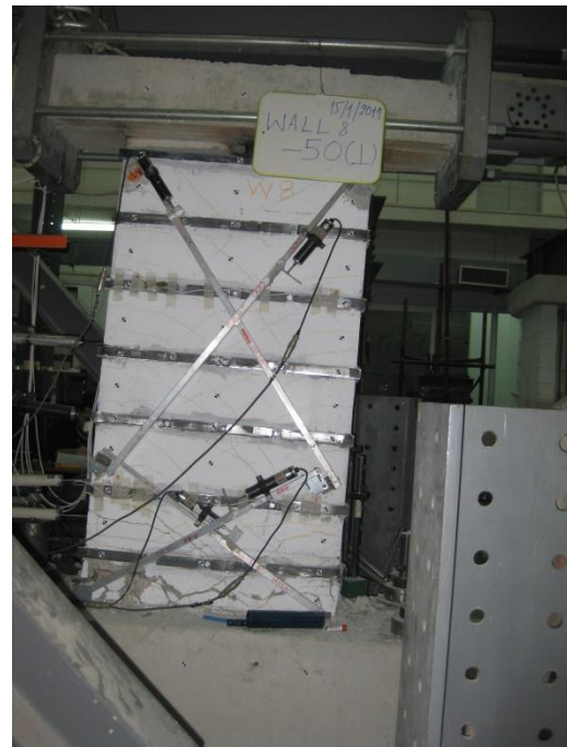
(β) Πίσω όψη τοιχείου για μετακίνηση -50\text{mm}
