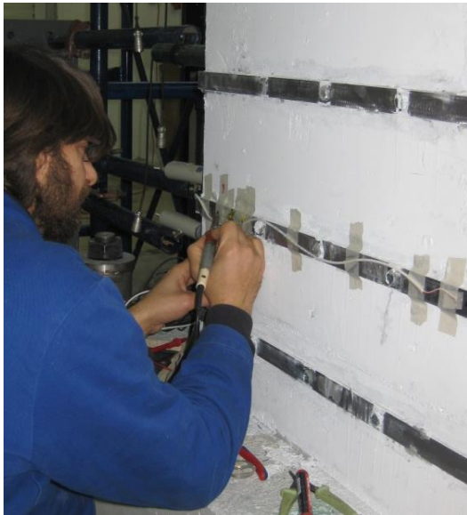
(α) Τοποθέτηση strain-gauges σε οριζόντια λάμα
