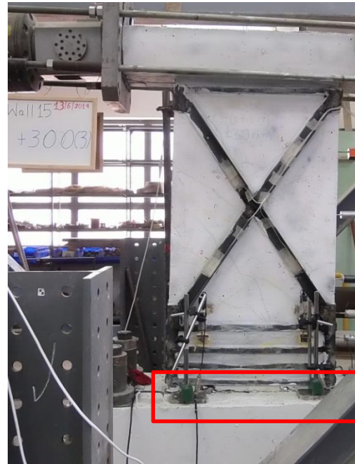
(β) Ρωγμές στον 3 ο κύκλο +30mm
