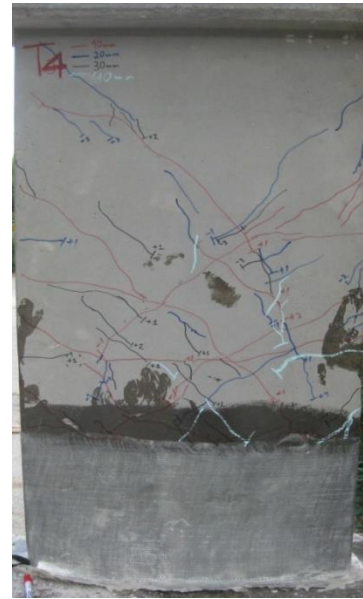
(β) Ρωγμές στους κύκλους των \pm 40\text{mm}
