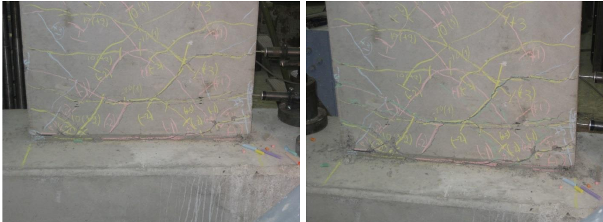
(α) Ρωγμές στους τρεις κύκλους των \pm 30\text{mm}
