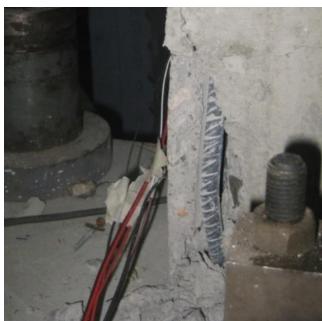
Σχήμα 4.27 Αποδιοργάνωση θλιβόμενης ζώνης κατά τον τρίτο κύκλο των \pm 20\text{mm} δοκιμίου W_6
