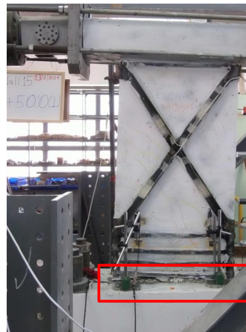
(β) Ρωγμές στον 1 ο κύκλο +50mm
