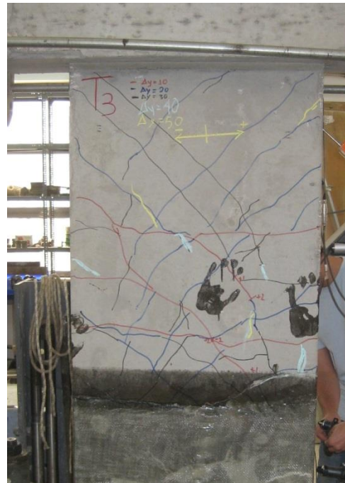
(β) Ρωγμές στους κύκλους των \pm 50\text{mm}
