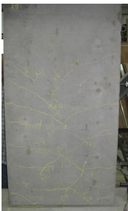
(α) Ρωγμές μετά το τέλος των \pm 10\text{mm}
