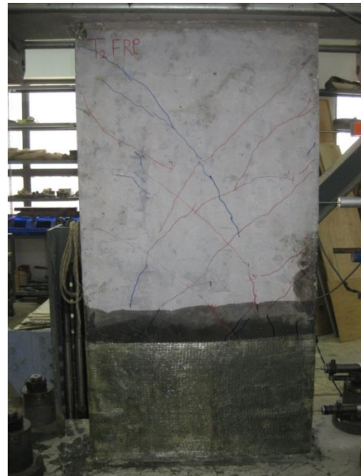
(β) Ρωγμές στον 3 ο κύκλο των \pm 20\text{mm}
