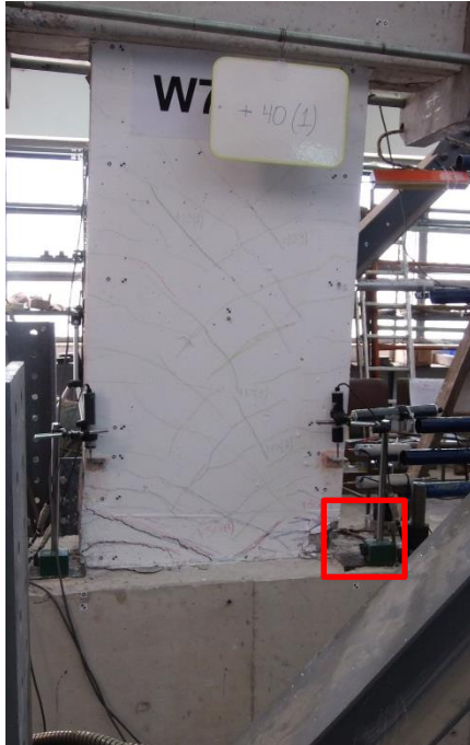
(α) Ρωγμές για μετακίνηση +40mm
