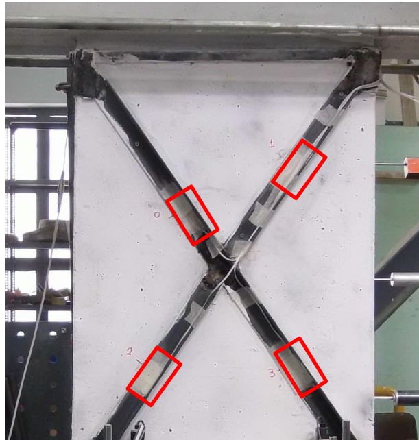
(β) Τέσσερα strain-gauges στην χιαστί ενίσχυση
