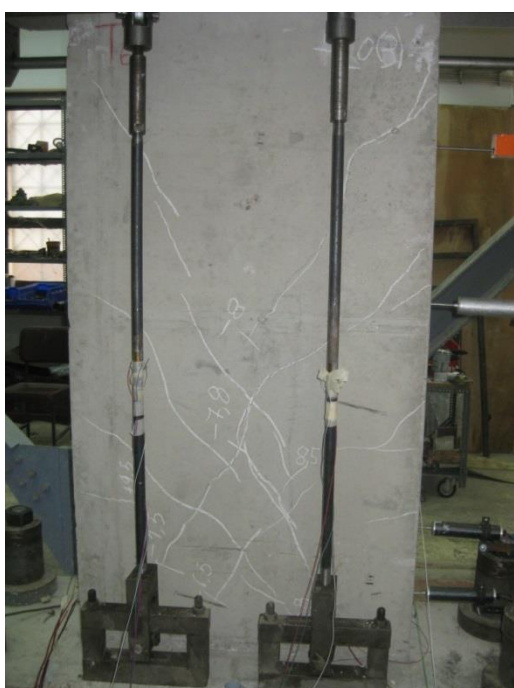
(α) Ρωγμές μετά το τέλος των \pm 10\text{mm}
