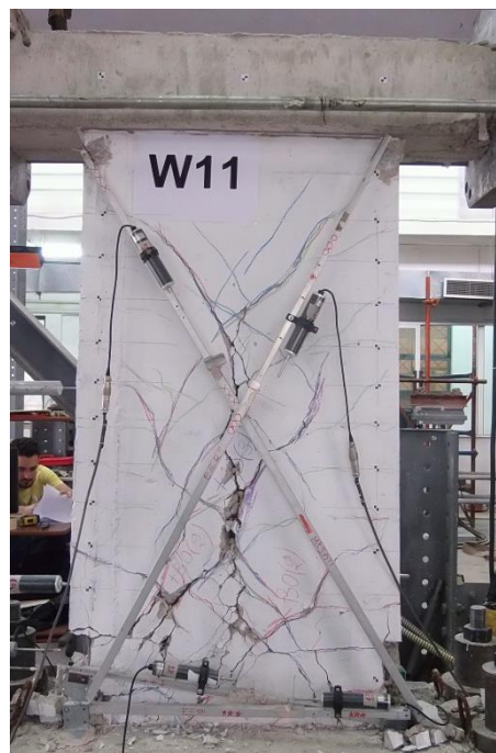
(β) Πίσω όψη τοιχίου μετά το τέλος του πειράματος
