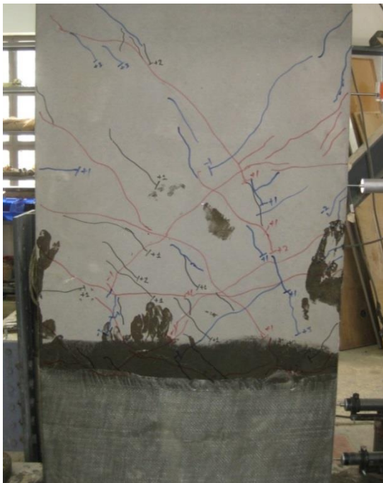
(α) Ρωγμές στους κύκλους των \pm 10\text{mm}
