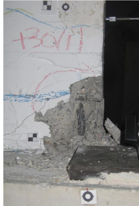
(β) Λυγισμός θλιβόμενης ράβδου για μετακίνηση +40mm
