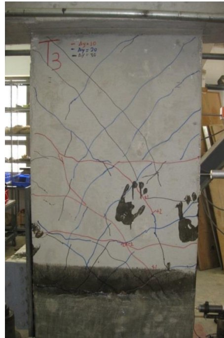
(β) Ρωγμές στους κύκλους των \pm 30\text{mm}
