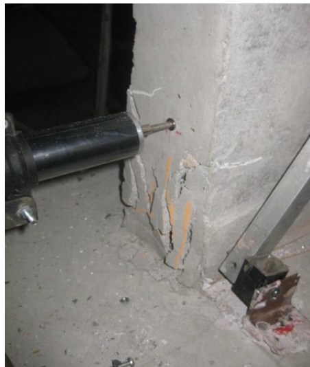
Σχήμα 4.17 Αποδιοργάνωση θλιβόμενης ζώνης για μετακίνηση +20\text{mm} τοιχίου W_5
