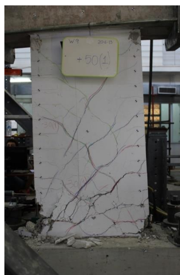
(β) Ρωγμές για μετακίνηση +50mm – Πίσω όψη (έχουν αφαιρεθεί τα χιαστί βελόμετρα)
