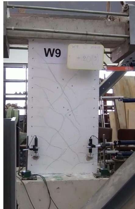
(β) Ρωγμές στον 3 ο κύκλο των \pm 20\text{mm}
