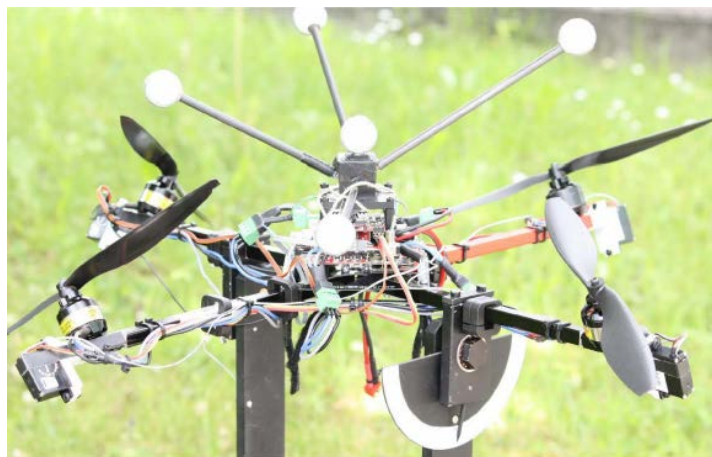
Σχήμα 1.11. Quadrotoρ με δυνατότητα tilting στο κάθε πόδι του [6].
