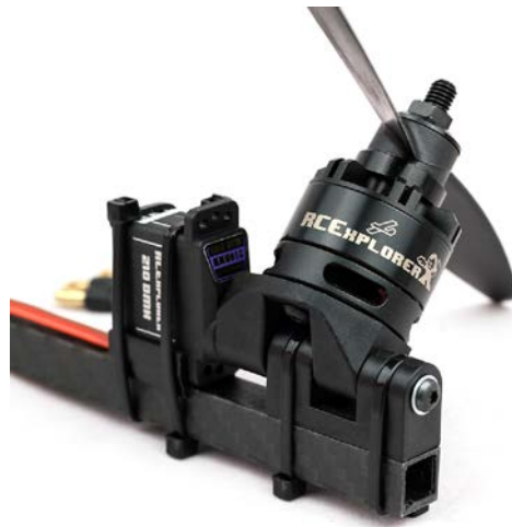
Σχήμα 1.6. Tilting του ηλεκτροκινητήρα μέσω ενός rc servo.
