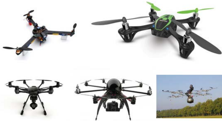
Σχήμα 1.2. Κατηγοριοποίηση multirotors σύμφωνα με τον αριθμό των ελίκων.
