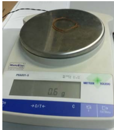
Σχήμα 5.91. Μέτρηση μάζας καλωδίου \Phi 0.9 και μήκους 29\text{cm} .
