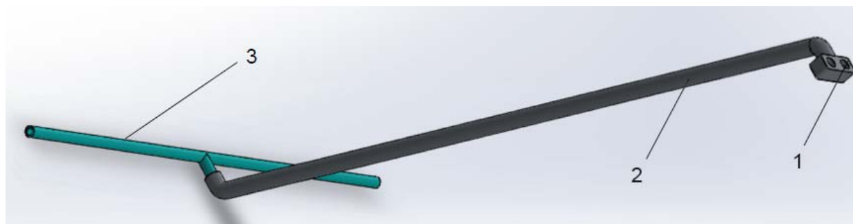
Σχήμα 5.86. Το ένα πόδι προσγείωσης Γ4 του ρομπότ (εκ των τριών).
