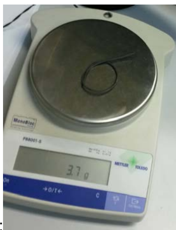
Σχήμα 5.90. Μέτρηση μάζας καλωδίου \Phi 2.5 και μήκους 29cm .
