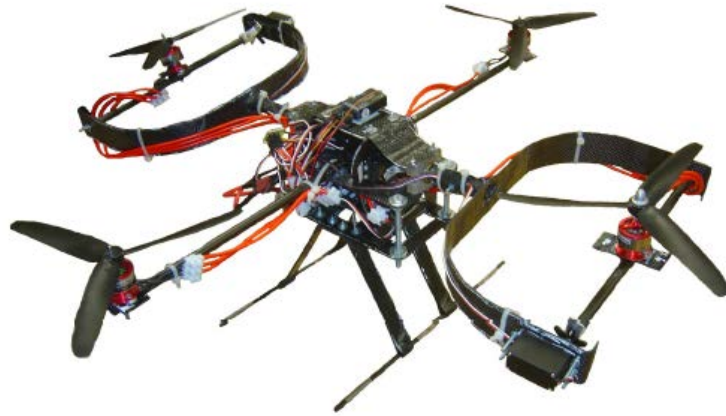
Σχήμα 1.12. Quadrotor με δύο έλικες κατευθυνόμενες στο χώρο [7].
