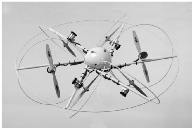
Σχήμα 1.10. Hexrotoρ αποτελούμενο από έλικες τοποθετημένες σε κεκλιμένα επίπεδα [5].
