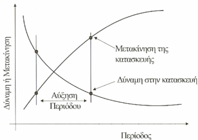
Εικ. 8.1 Μείωση των σεισμικών δυνάμεων και αύξηση των μετακινήσεων της κατασκευής λόγω επιμήκυνσης της θεμελιώδους ιδιοπεριόδου
