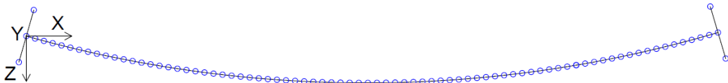
Εικ. 6.9 Σύστημα αξόνων τοποθετημένο στον πρώτο κόμβο σύμφωνα με την κάτοψη της γέφυρας.
