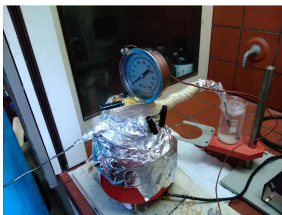
Εικόνα 7.2 α) Εξωτερικός μανδύας με μόνωση β) Ρυθμιστής θερμοκρασίας γ) Διάταξη εν λειτουργία
