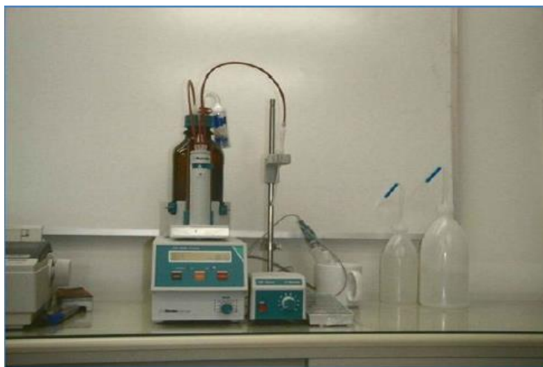
Εικόνα 5.9 Αυτόματος τιτλοδοτής για τον αναλυτικό προσδιορισμό ακραίων ομάδων (716 DMS Titrino, Brinkmann Instruments, INC.).
