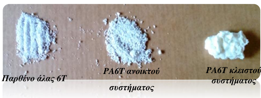
Εικόνα 3.8 Αξιολόγηση διατήρησης στερεάς κατάστασης με βάση το αλάτι 6T.
