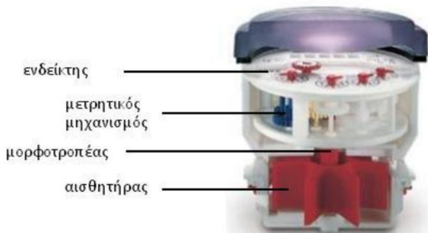
Σχήμα 2.4 : Βασικά δομικά στοιχεία υδρομετρητή (Καστορίνης, 2014).
