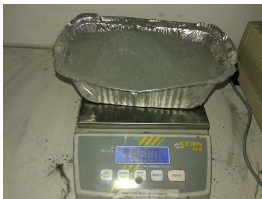
Εικόνα 18: Ζύγιση στερεού μείγματος γραφίτη-μπεντονίτη
