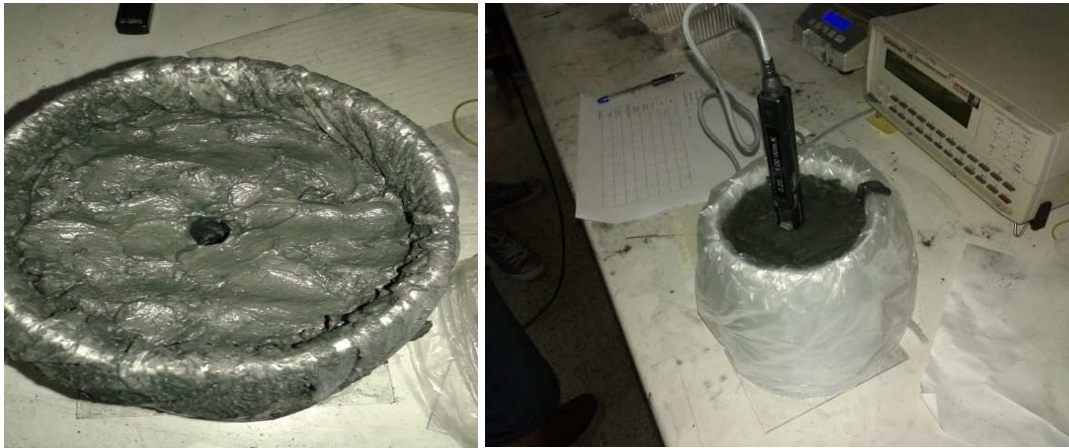
Εικόνα 21: Ένεμα ομάδας A μετά από μέτρηση ηλεκτρικής αντίστασης και ένεμα ομάδας B κατά την διάρκεια μέτρησης θερμικής αγωγιμότητας
