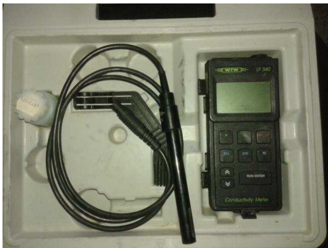
Εικόνα 17: Μετρητής ηλεκτρικής αγωγιμότητας νερού
