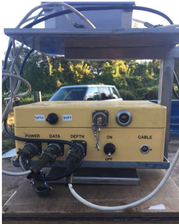
Σχήμα 3 Κέντρο Ελέγχου και Καταγραφής
