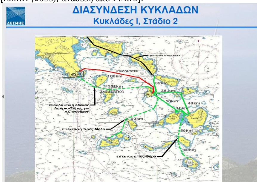
Χάρτης 4.12 Επέκταση της διασύνδεσης των Κυκλάδων βάσει σχεδίου "Κυκλάδες Ι" (Στάδιο 2) και μελλοντική διασύνδεση της Μήλου για αξιοποίηση του γεωθερμικού δυναμικού
