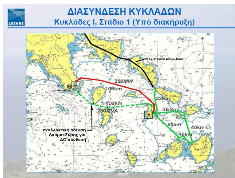
Χάρτης 4.11 Επέκταση διασύνδεσης Κυκλάδων βάσει σχεδίου "Κυκλάδες Ι" (Στάδιο 1)
