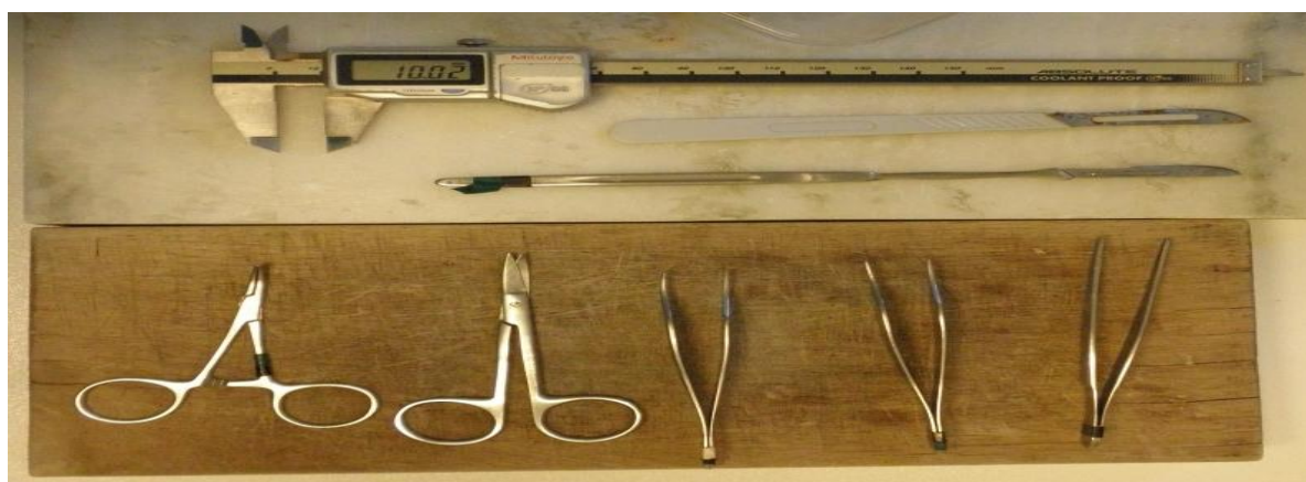
Εικόνα 7.1 : Βασικά εργαλεία πειραματικού εξοπλισμού: (α) ψηφιακό παχύμετρο, (β) χειρουργικά νυστέρια, (γ) λαβίδες, (δ) ψαλιδάκια και (ε,στ) επιφάνειες κοπής δειγμάτων.
