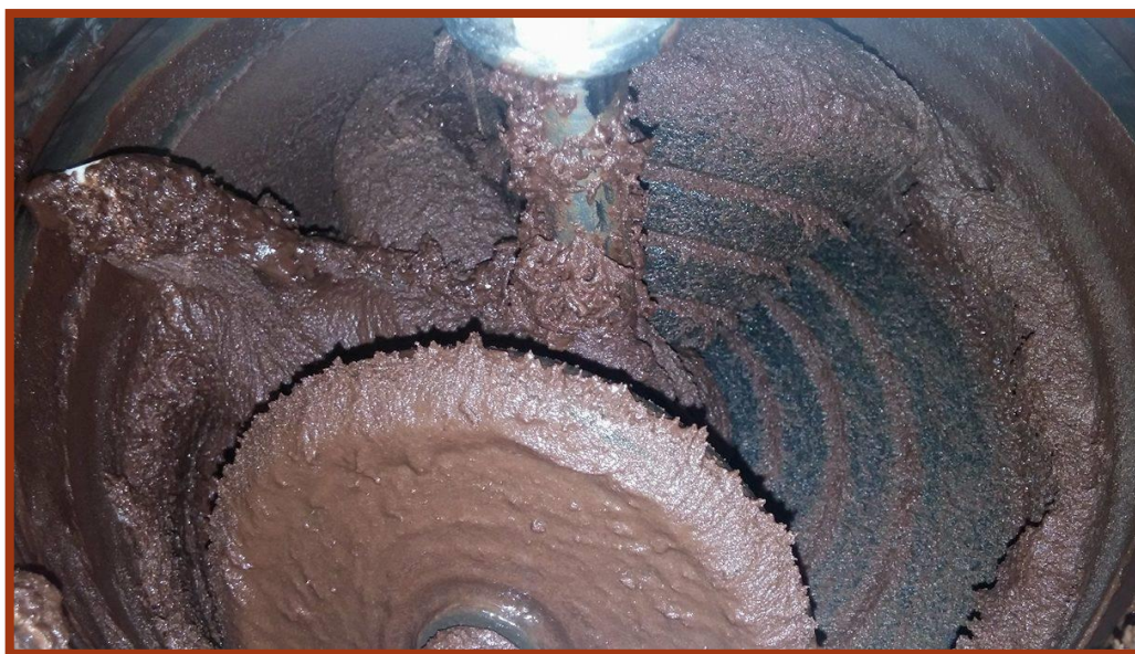
Εικόνα 9. Ο κάδος του Melanger με το δείγμα στα αρχικά στάδια της ανάμειξης (αυξημένη κοκκομετρία)
