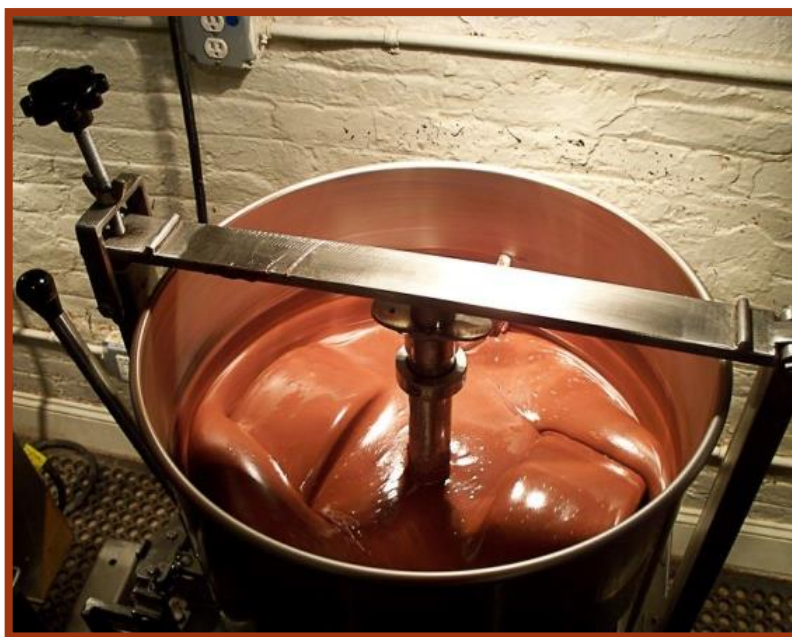
Εικόνα 4. Melanger βιομηχανικού τύπου (μηχάνημα στο οποίο γίνεται το ραφινάρισμα και το conching)
