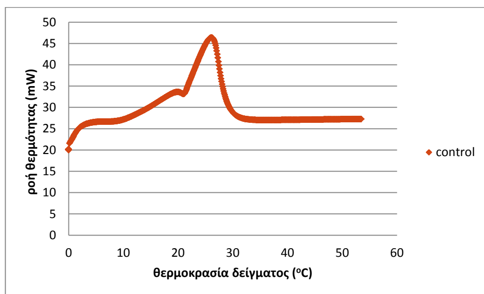
Διάγραμμα 17. Διάγραμμα DSC (ροή θερμότητας συναρτήσει της θερμοκρασίας του δείγματος) σε δείγμα αναφοράς
