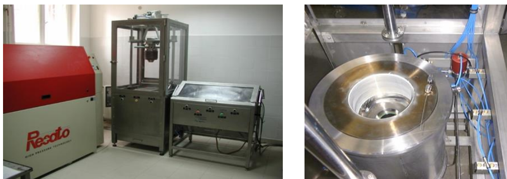
Εικόνα 5.3: Διάταξη του εξοπλισμού Υπερυψηλής Πίεσης. Στην δεύτερη εικόνα φαίνεται ο κυλινδρικός θάλαμος όπου εισάγεται το προϊόν.
