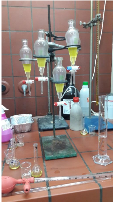
Εικόνα 5.5: Διάταξη για την εκχύλιση των φαινολικών ενώσεων του ελαιόλαδου
