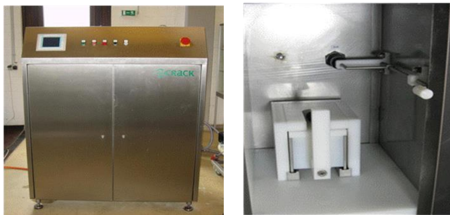
Εικόνα 5.4: Διάταξη του εξοπλισμού των Παλμικών Ηλεκτρικών Πεδίων που χρησιμοποιήθηκε. Στην δεύτερη εικόνα φαίνεται ο θάλαμος διαλείποντος έργου.
