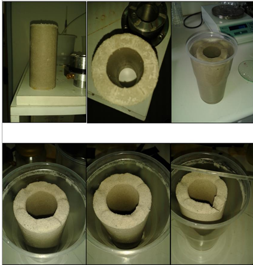
Σχήμα 2.5 Σταθεροποιημένο δοκίμιο άμμου με CS=10%wt. Πάνω αριστερά και στη μέση: το δοκίμιο αμέσως μετά την ωρίμανση των 30 ημερών, χωρίς να υποστεί διάτμηση. Πάνω δεξιά: το δοκίμιο μετά την αποθήκευση μέσα σε νερό για 45 ημέρες. Κάτω αριστερά: το δοκίμιο εκτεθειμένο στον αέρα για 8 ώρες. Κάτω στη μέση και δεξιά: Το δοκίμιο εκτεθειμένο στον αέρα για 3 ημέρες. Η άμμος καταρρέει με το άγγιγμα. Πηγή: Τριαντάφυλλος (2015).
