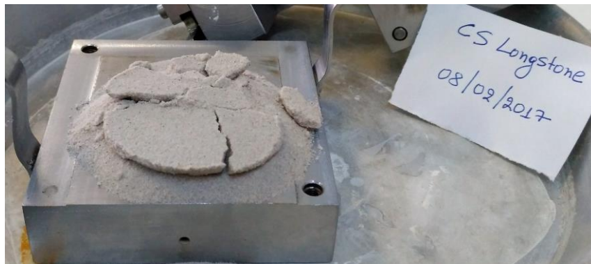
Σχήμα 6.21 Φωτογραφίες πριν (επάνω) και μετά (κάτω) τη διάτμηση μερικώς κορεσμένου σταθεροποιημένου δοκιμίου άμμου Longstone.
