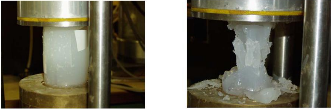
Σχήμα 2.13 Ανεμπόδιστη θλίψη δοκιμίου καθαρής πυριτίας CS=6.5%, ύστερα από ωρίμανση 30 ημερών μέσα σε νερό. Παρουσιάζονται: (α) τα διαγράμματα των αποτελεσμάτων της δοκιμής και (β) φωτογραφίες του δοκιμίου πριν και μετά τη δοκιμή. Πηγή: Towhata (2008).
