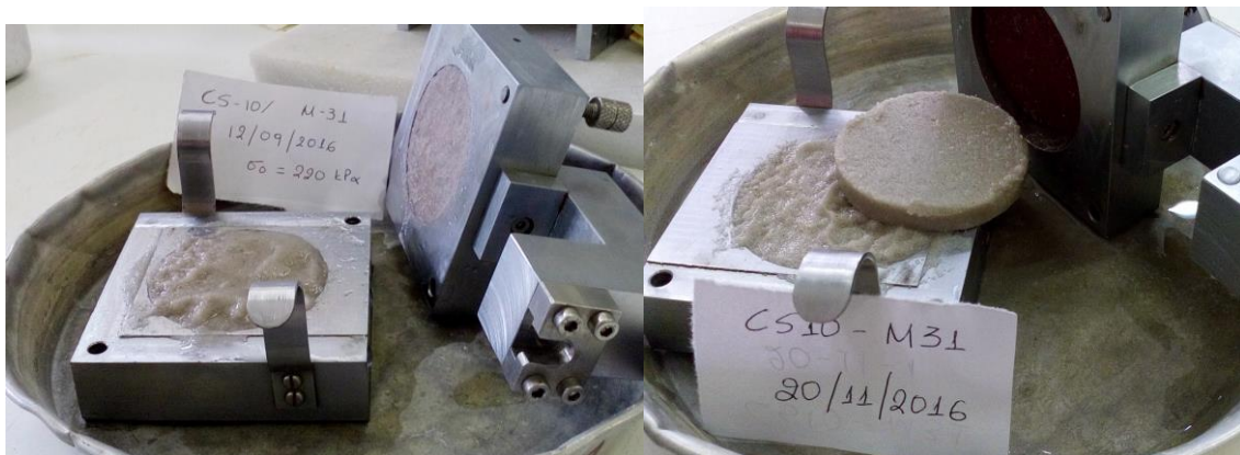
Σχήμα 6.11 Φωτογραφίες σταθεροποιημένων με κολλοειδή πυριτία δοκιμών άμμου Μ31, μετά από τη διάτμηση.
