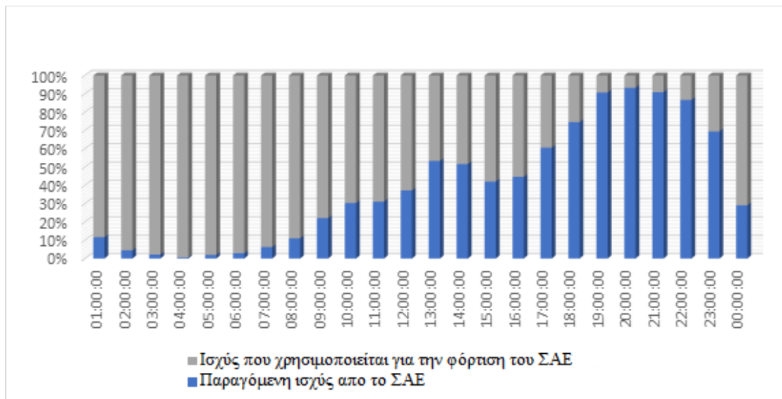
Διάγραμμα 7-5. Μέση κατάσταση φόρτισης / αποφόρτισης 24-ώρου σε ένα έτος (NaS)
