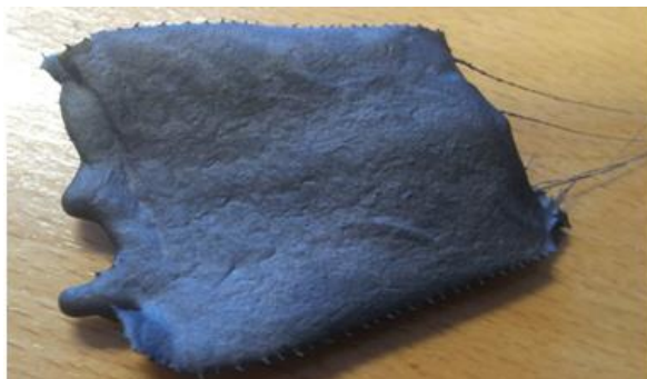
Σχήμα 10.60: Στρώση από σπρέι γραφίτη πάνω σε κομμάτι φύλλου αλόης.
