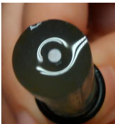
Σχήμα 13.92: Φωτογραφία επιφάνειας ηλεκτροδίου χαλκού. Διαβροχή της ρητίνης του ηλεκτροδίου, αλλά απουσία διαβροχής στο σημείο όπου έχει γίνει εναπόθεση μυριστικών αλάτων λανθανίου.
