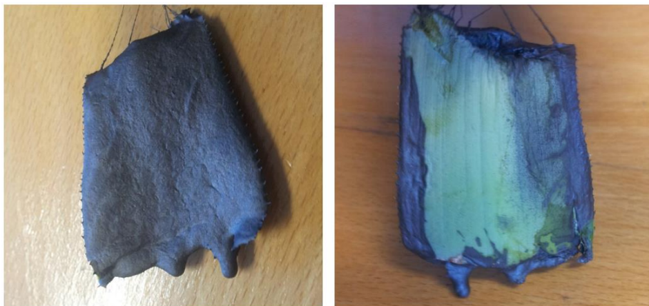
Σχήμα 15.113: Στρώση γραφίτη πάνω σε κομμάτι φύλλου αλόης, έπειτα από ψεκασμό της επιφάνειας με σπρέι γραφίτη. Μπροστινή όψη φύλλου (αριστερά), πίσω όψη (δεξιά).
