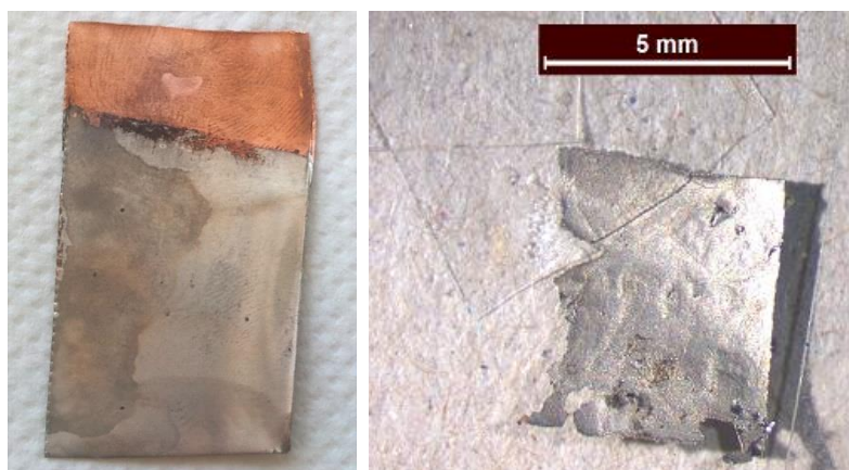
Σχήμα 13.83: Εναποθέσεις νικελίου δοκιμαστικών πειραμάτων: Επινικέλωση κοινού υποστρώματος χαλκού (αριστερά). Επινικέλωση βιομιμητικού υποστρώματος χρυσού από αλόη (δεξιά).
