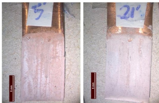
Σχήμα 14.100: Φωτογραφίες εναποθέσεων μυριστικών αλάτων του λανθανίου πάνω σε φύλλα χαλκού, για χρόνο εναπόθεσης 5 λεπτών στα 20 V (αριστερά), και 21 λεπτών στα 30 V (δεξιά).
