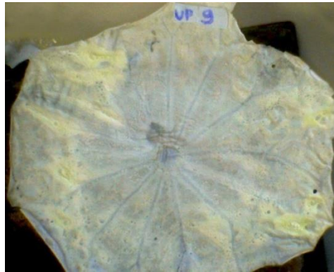
Σχήμα 12.75: Μembrάνη κυτταρίνης με αποτύπωση της επιφανειακής δομής ενός φύλλου λωτού.
