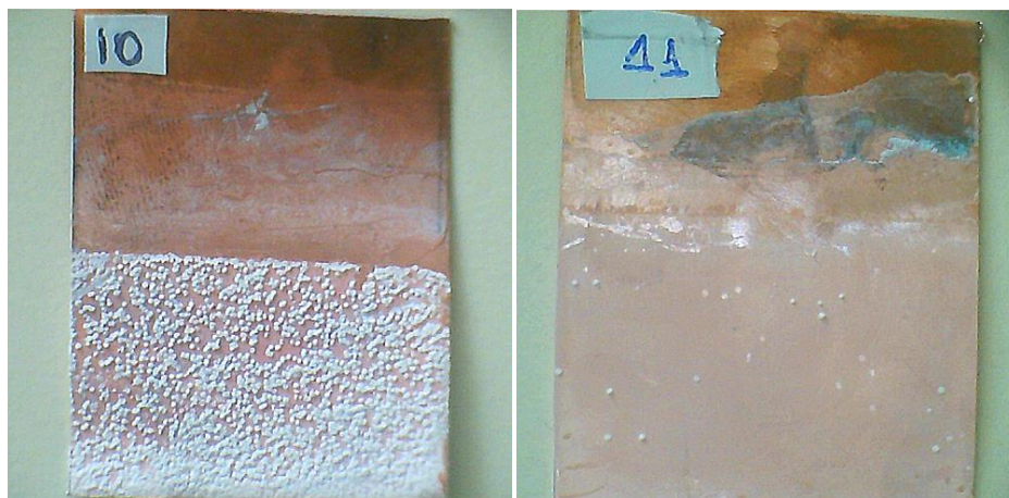
Σχήμα 11.68: Εναποθέσεις μυριστικού άλατος του λανθανίου πάνω σε υποστρώματα χαλκού. Μη προεπεξεργασμένο υπόστρωμα (αριστερά). Υπόστρωμα επεξεργασμένο με μηχανική και ηλεκτροχημική λείανση, και ενεργοποίηση σε HCl 10% (δεξιά).
