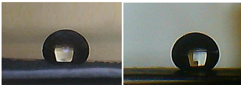
Σχήμα 11.69: Φωτογραφίες από σταγόνα νερού πάνω σε υδρόφοβες εναποθέσεις μυριστικού άλατος του λανθανίου σε υποστρώματα χαλκού. Δοκίμιο (Δείγμα #10) χωρίς προεπεξεργασία (αριστερά). Δοκίμιο (Δείγμα #11) με προεπεξεργασία (δεξιά).
