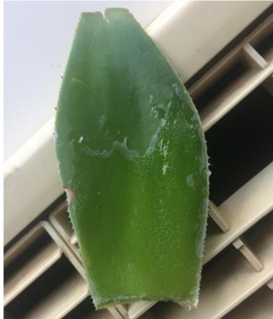
Σχήμα 7.40: Ρευστό διάλυμα αποτύπωσης οξικής κυτταρίνης/ακετόνης πάνω σε φύλλο αλόης.
