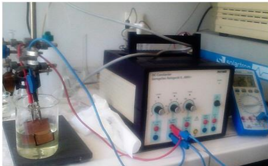
Σχήμα 6.38: Διάταξη ηλεκτροχημικής εναπόθεσης για εναπόθεση μυριστικού άλατος του μαγγανίου σε υπόστρωμα χαλκού.
