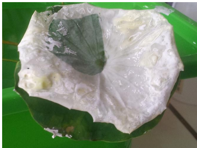
Σχήμα 7.41: Φωτογραφία ημι-στερεοποιημένης μεμβράνης οξικής κυτταρίνης, πάνω σε νεαρό φύλλο λωτού. Μερικός διαχωρισμός από την επιφάνεια του βιολογικού δείγματος.
