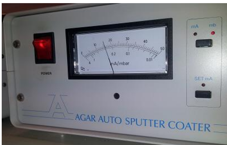
Σχήμα 7.43: Όργανο επιχρύσωσης: Agar Auto Sputter Coater.
