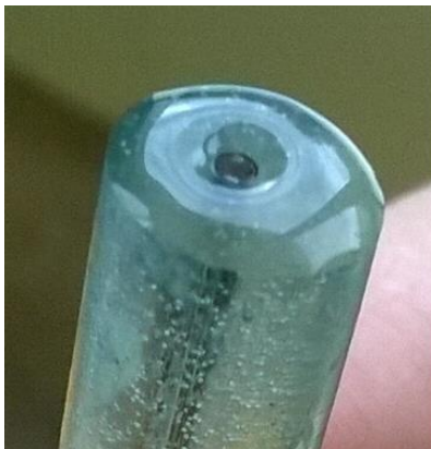
Σχήμα 13.97: Φωτογραφία επιφάνειας ηλεκτροδίου χαλκού. Διαβροχή της ρητίνης του ηλεκτροδίου, αλλά απουσία διαβροχής στο σημείο όπου έχει γίνει εναπόθεση μυριστικών αλάτων του μαγγανίου.
