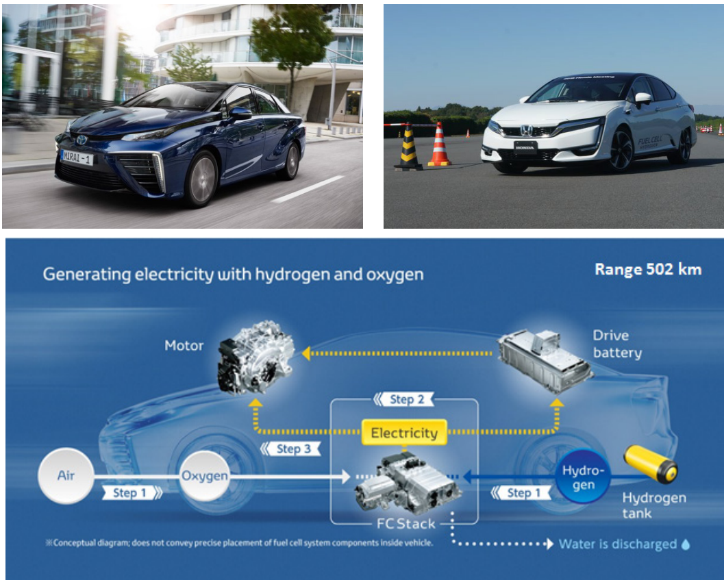
Σχήμα 1.1.1: Τα υδρογονοκίνητα αυτοκίνητα Toyota Mirai και Honda FCX Clarity (πάνω) και σχηματική απεικόνιση του τρόπου λειτουργίας ενός αυτοκινήτου κυψέλης υδρογόνου από την Toyota (κάτω).
