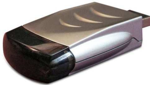
Σχήμα 3.6 Συσκευή υπέρυθρης επικοινωνίας που συνδέεται σε υπολογιστή μέσω θύρας USB [7].
