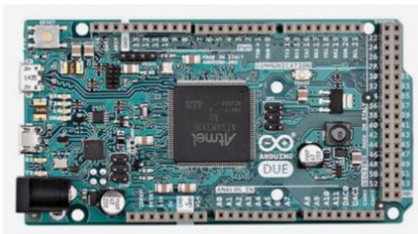
Σχήμα 6.35 Το σύστημα Arduino DUE [58].
