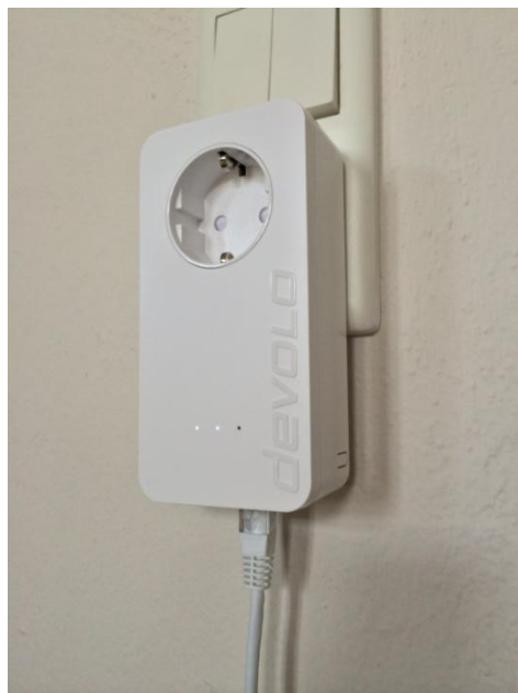
Σχήμα 3.4 Δείγμα Power Line modem [5].
