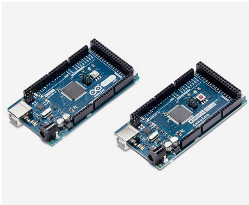
Σχήμα 6.1 Η μονάδα Arduino MEGA 2560 στην οποία βασίζεται το κυριότερο μέρος του μετρητή [30].
