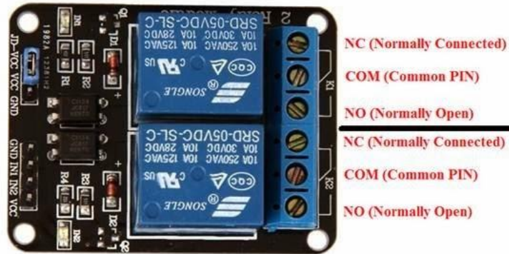
Σχήμα 6.31 Η μονάδα αποσύνδεσης/επανασύνδεσης του καταναλωτή [57].
