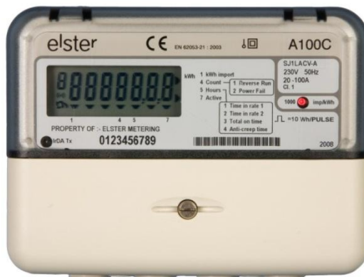
Σχήμα 1.3 Έξυπνος μετρητής, μονοφασικός, της εταιρείας Elster [22].
