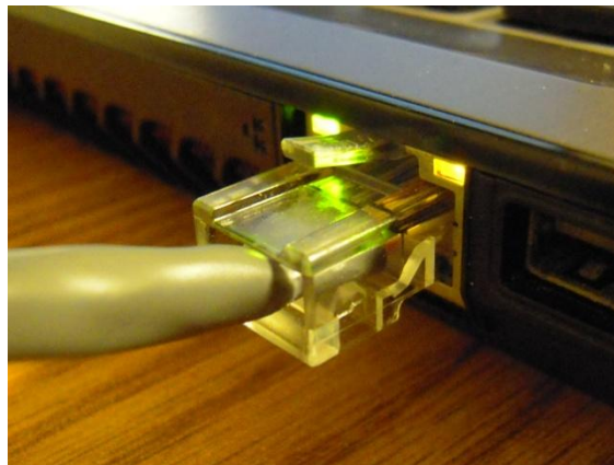
Σχήμα 3.11 Τυπικό καλώδιο σύνδεσης Ethernet [17].
