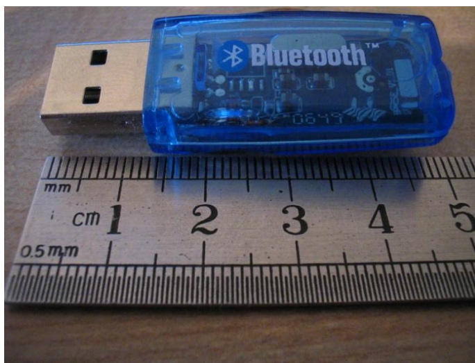
Σχήμα 3.7 Συσκευή Bluetooth για σύνδεση με ηλεκτρονικό υπολογιστή μέσω θύρας USB [8].
