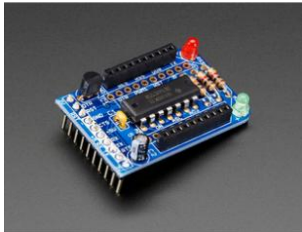
Σχήμα 6.15 Το Xbee adapter [45].
