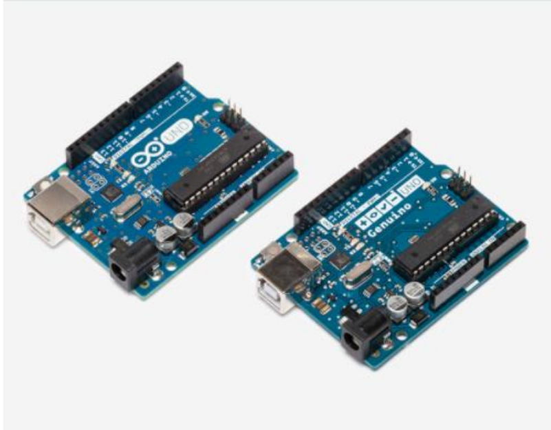
Σχήμα 6.40 Το σύστημα Arduino UNO R3 [70].
