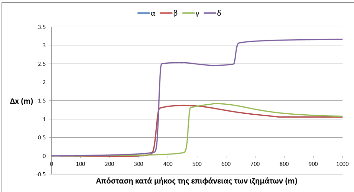
Διάγραμμα 5.4: Οριζόντια μετατόπιση της επιφάνειας ιζηματογενούς στρώσης ( \Delta x ) με H=150\text{ m} η οποία βρίσκεται πάνω σε κανονικό ρήγμα όπου διαρρηγνύεται υποθέτοντας 4 περιπτώσεις: α) αργιλικά ιζήματα με \theta=30^\circ , β) αργιλικά ιζήματα με \theta=60^\circ , γ) αμμώδη ιζήματα με \theta=60^\circ , δ) αμμώδη ιζήματα με \theta=30^\circ
