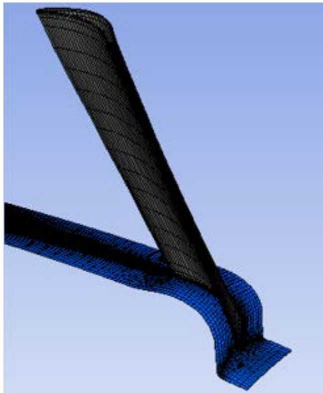
Εικόνα 5.2 3-D πλεγματοποίηση του στάτορα και εσωτερικό 3D πλέγματος στάτορα
