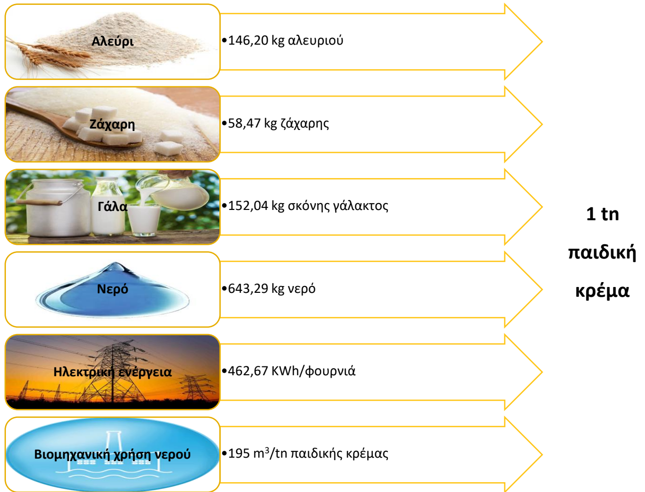
Σχήμα 4: Σχηματική απεικόνιση του ισοζυγίου μάζας και ενέργειας για τη παραγωγή της παιδικής κρέμας
