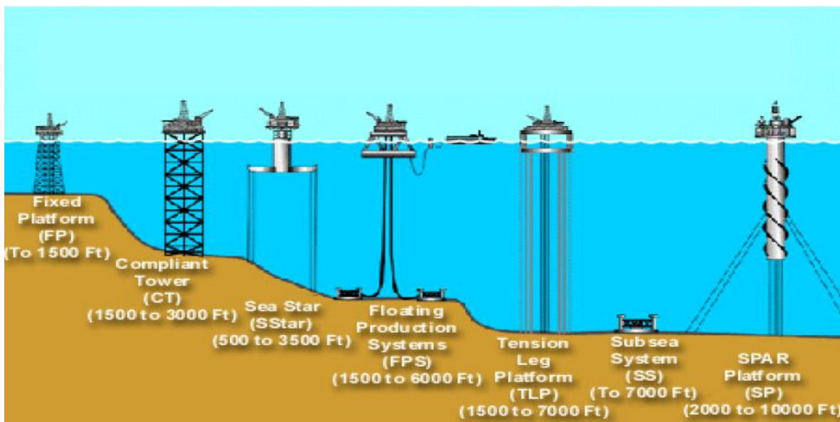
Εικόνα 2. 1: Είδη διαφορετικών θεμελιώσεων συναρτήσει του βάθους
