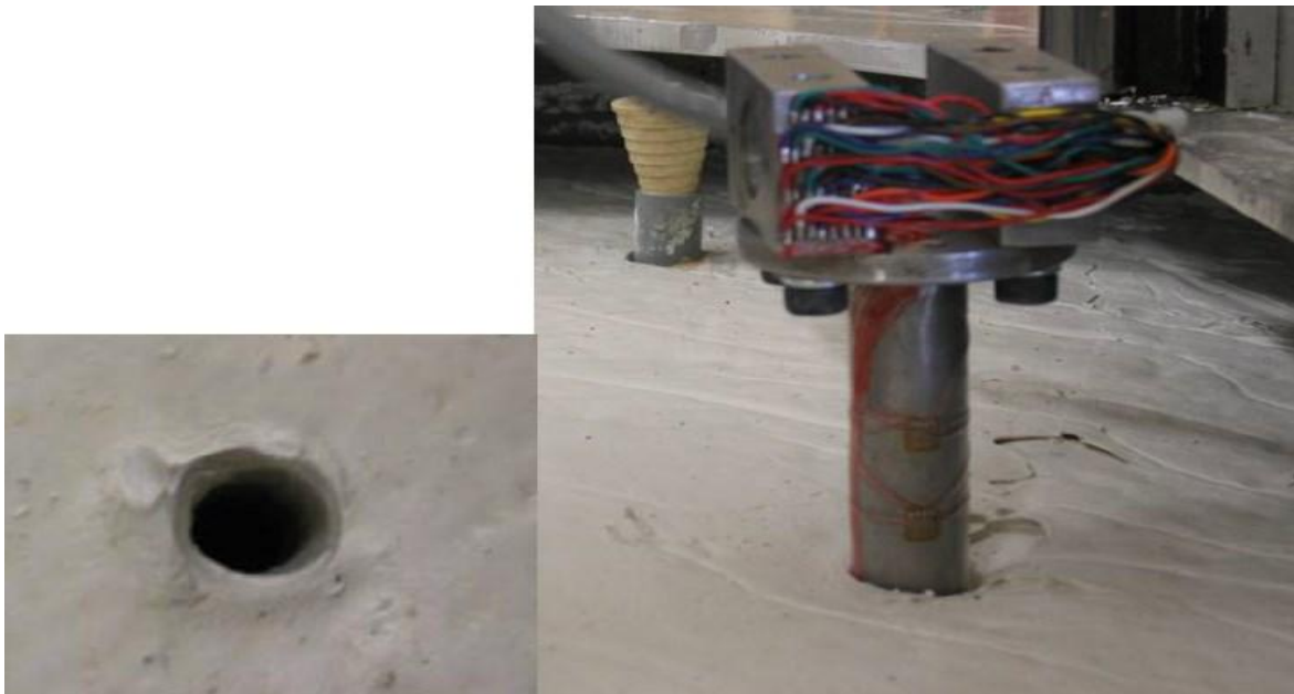
Εικόνα 3. 3: Πείραμα Jeanjean (2009): Όψη της γεώτρησης, (αριστερά) και πειραματική διάταξη φυγοκεντρητή (δεξιά)
