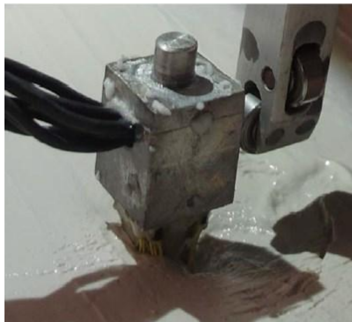
Εικόνα 3. 6: Όψη διάταξης φόρτισης κεφαλής πασσάλου, Lehane (2014)
