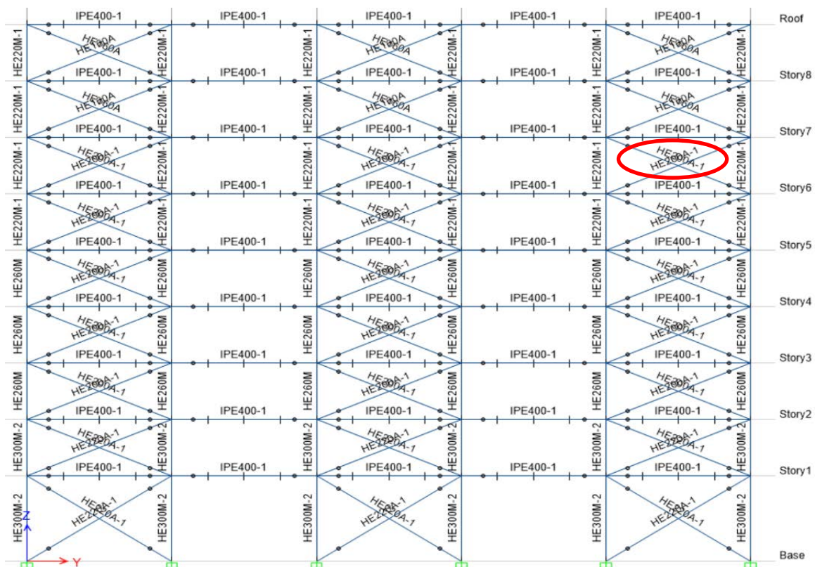
Σχήμα 4.21 Απεικόνιση θέσης δυσμενέστερου χιαστί HE160
