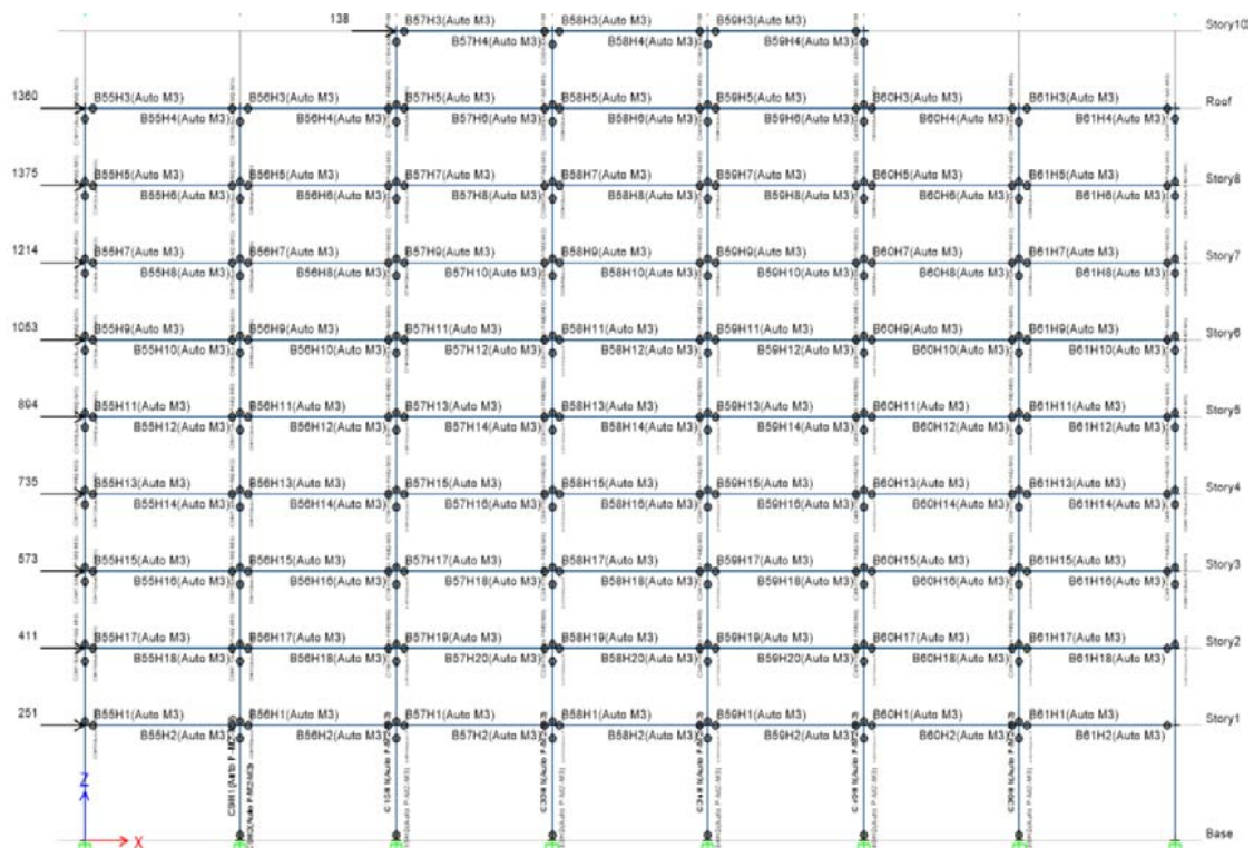
Σχήμα 6.7 Ορισμός θέσεων δημιουργίας πλαστικών αρθρώσεων και επιβολή πλευρικής φόρτισης
