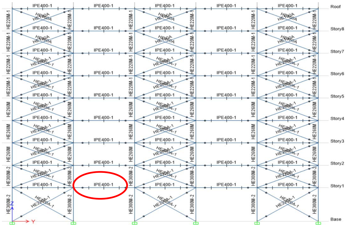
Σχήμα 4.6 Απεικόνιση θέσης δυσμενέστερης δοκού IPE400
