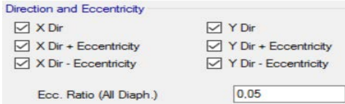
Σχήμα 5.6 Ορισμός τυχηματικής εκκεντρότητας e_x και e_y
