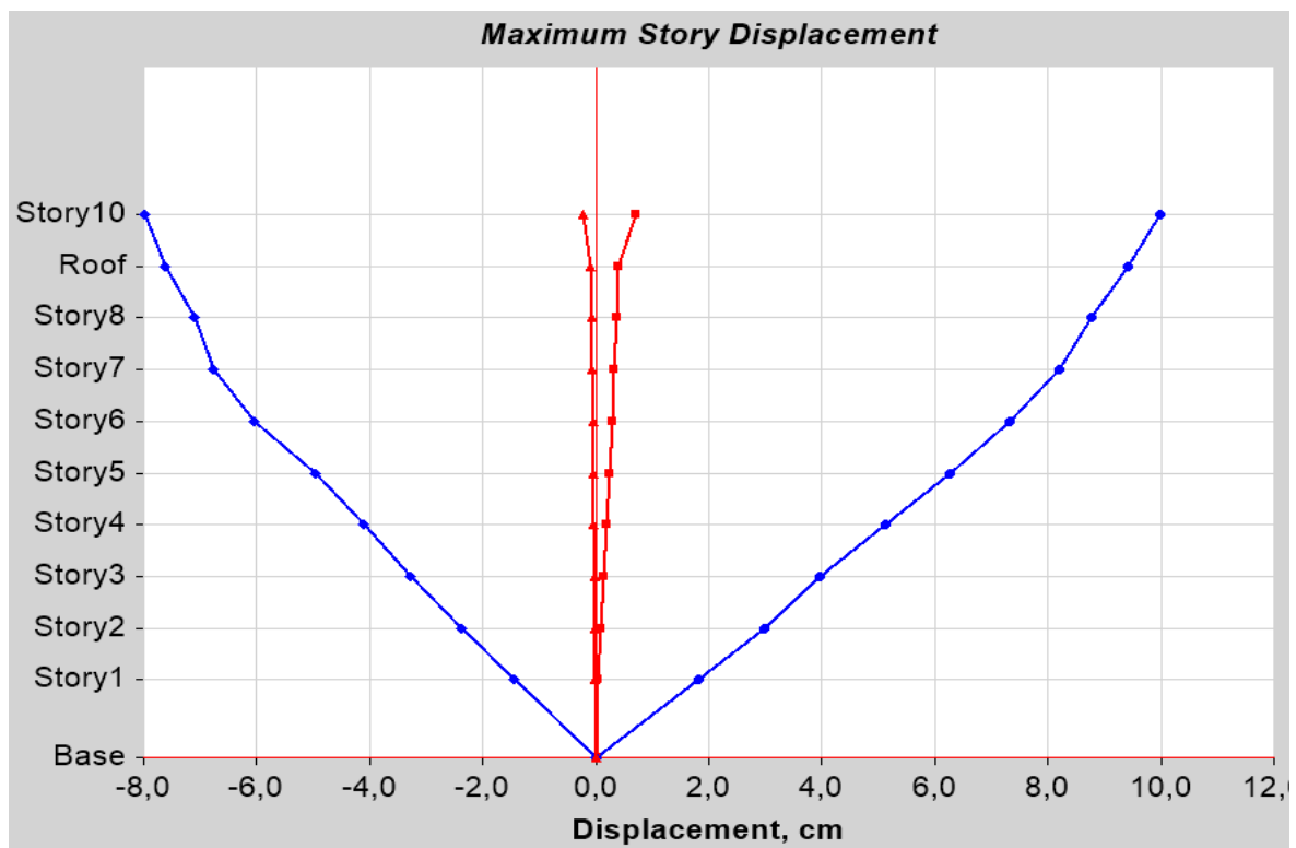
Σχήμα 7.14 Διάγραμμα μέγιστης μετακίνησης ορόφων Frequency Domain
