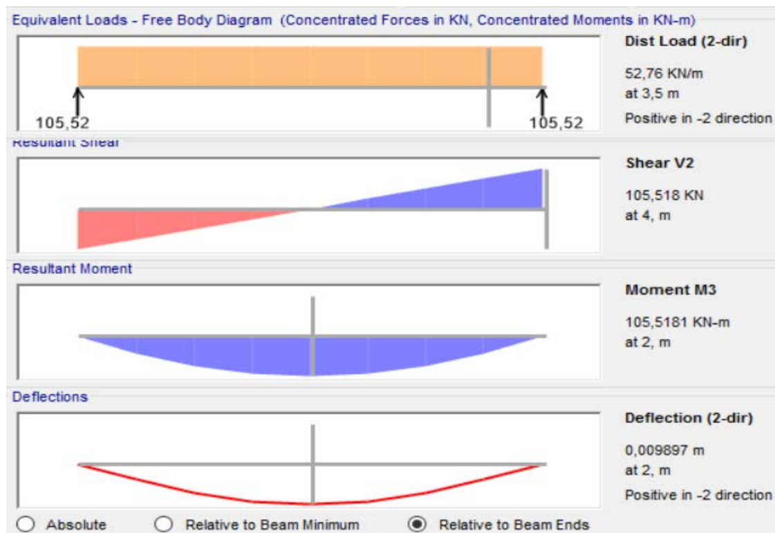
Σχήμα 8 Διάγραμμα εντατικών μεγεθών μέλους IPE300
