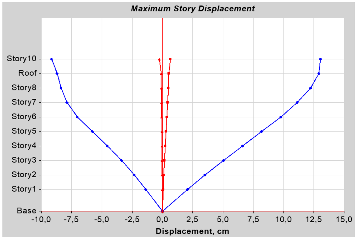
Σχήμα 7.13 Διάγραμμα μέγιστης μετακίνησης ορόφων Frequency Domain
