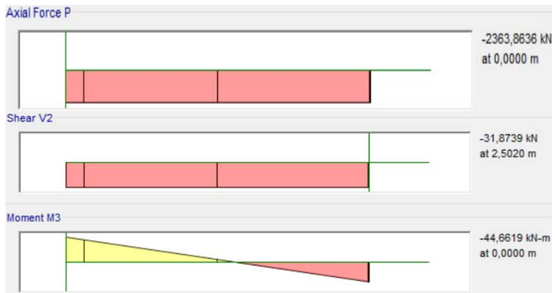
Σχήμα 4.16 Διαγράμματα εντατικών μεγεθών μέλους HEM 220
