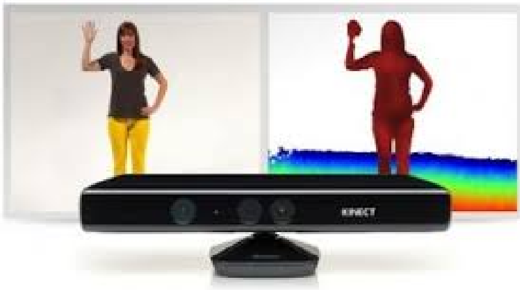
Σχήμα 2.9: Κάμερα Kinect για εντοπισμό χειρονομιών σε εφαρμογές αναγνώρισης
