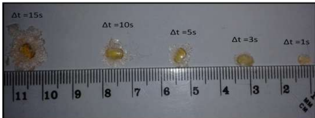
Εικόνα 54 Εκτίμηση διαστάσεων προβολής της δέσμης λέιζερ για διαφορετικούς χρόνους εστίασης
