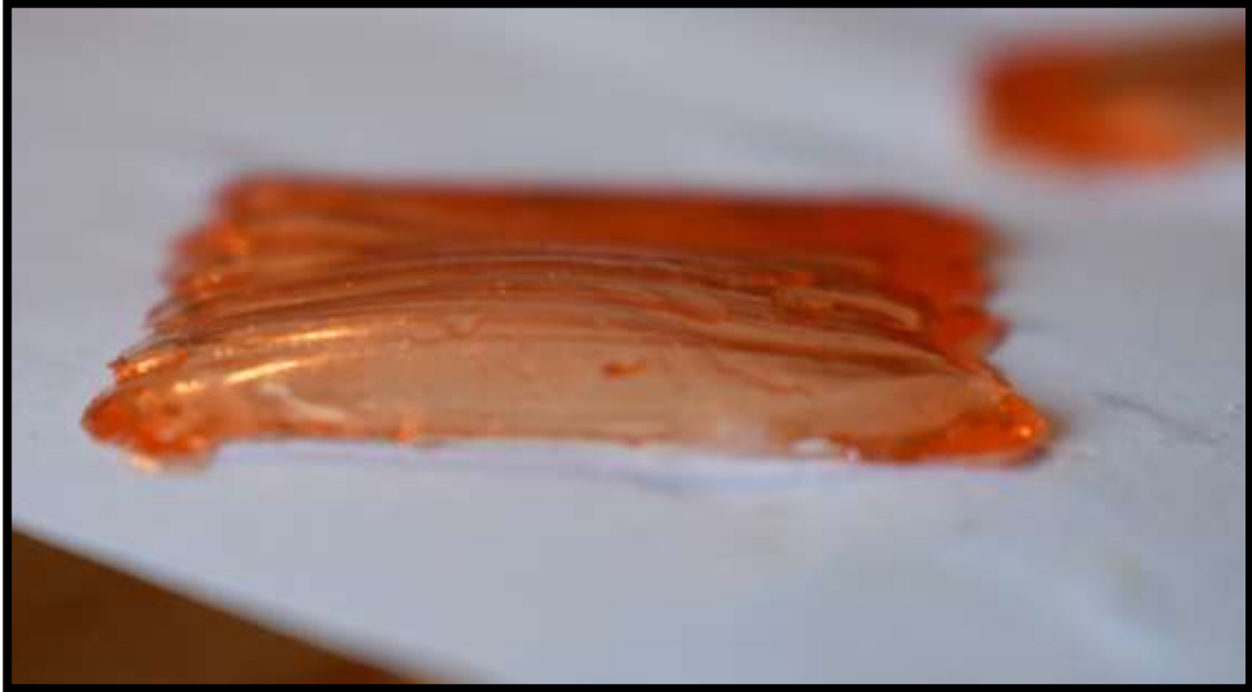
Εικόνα 74 Φαινόμενο κύρτωσης λόγω επαναλαμβανόμενων σαρώσεων
