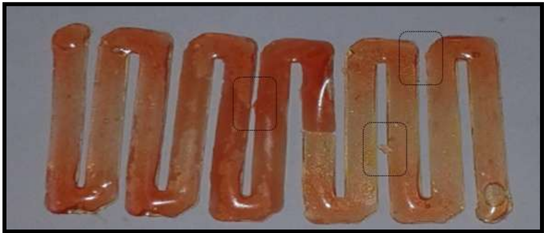
Εικόνα 62 Εκτύπωση δοκιμαστικού τεμαχίου με ταχύτητα σάρωσης 1.5 m/min
