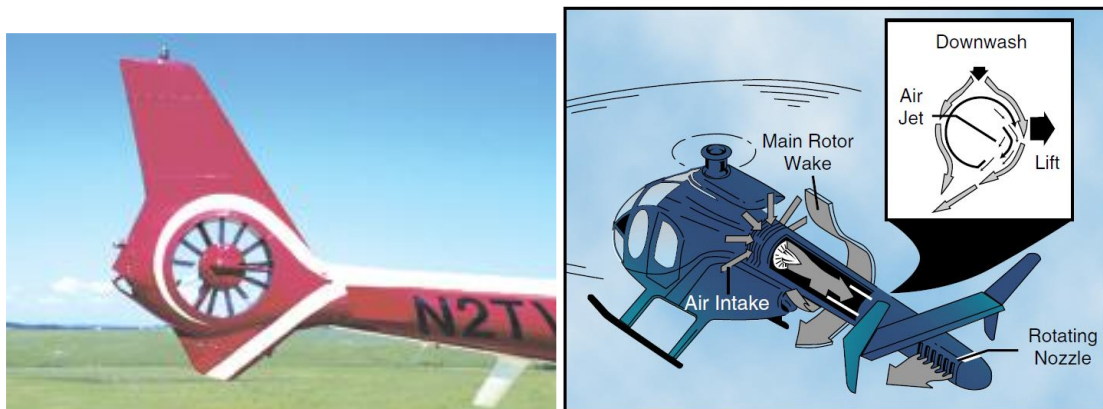
Εικ. 4 Διάφορες διατάξεις για τη δημιουργία “αντι-ροπής” του κύριου στροφέιου.
