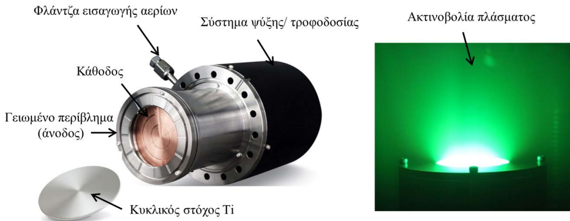
Εικόνα 1.7: Πηγή μαγνητικά υποβοηθούμενης ιοντοβολής (αριστερά). Ακτινοβολία πλάσματος πάνω από πηγή μαγνητικά υποβοηθούμενης ιοντοβολής (δεξιά).
