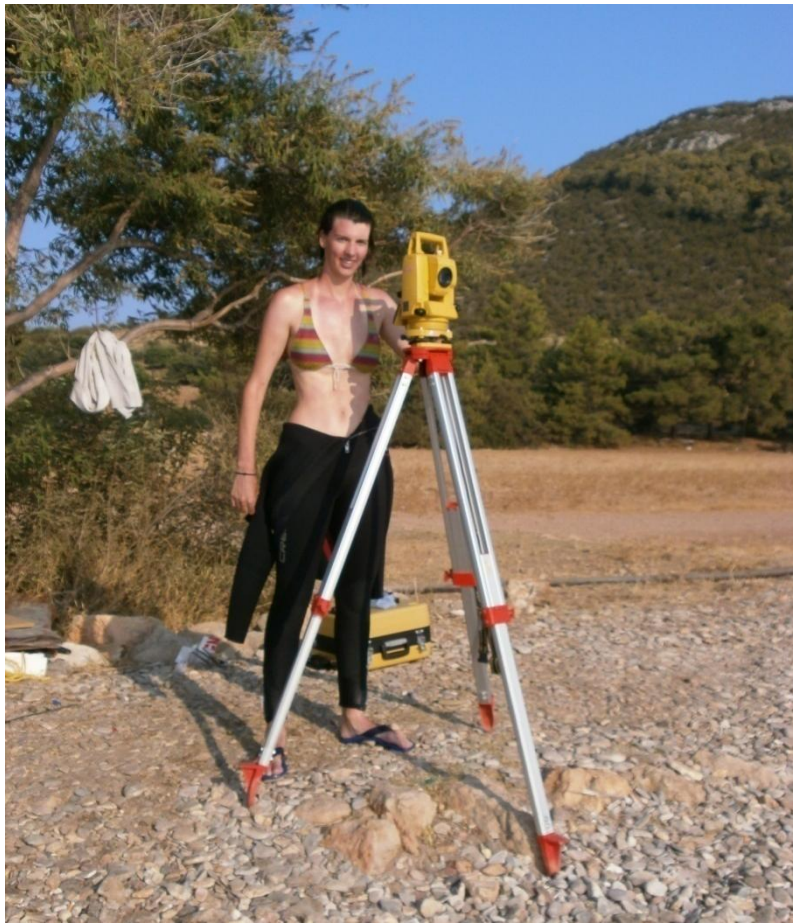
Εικόνες 3.7, 3.8. Γεωδαιτικός σταθμός Topcon 239n
