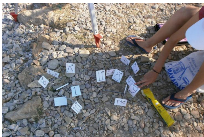
Εικόνες 3.14, 3.15. Εργασία για την επισήμανση των σημείων τριπλευρισμού
