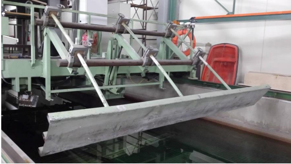
Εικόνα 5: Μηχανισμός απόσβεσης κυμάτων
