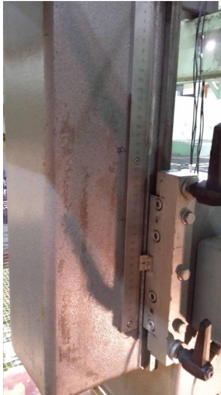
Εικόνα 7: Κλίμακα για τη βαθμονόμηση του Heave
