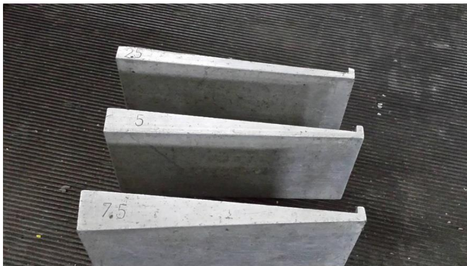
Εικόνα 8: Κλίμακα για τη βαθμονόμηση του Pitch
