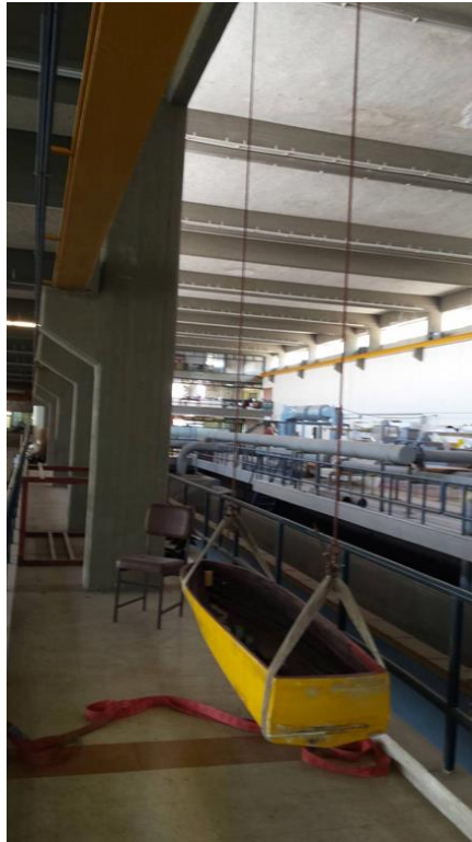
Εικόνα 3: Το μοντέλο 113/95 δεμένο σε μάντρες για την εύρεση της ακτίνας αδράνειας και περιόδου ιδιοταλάντωσης
