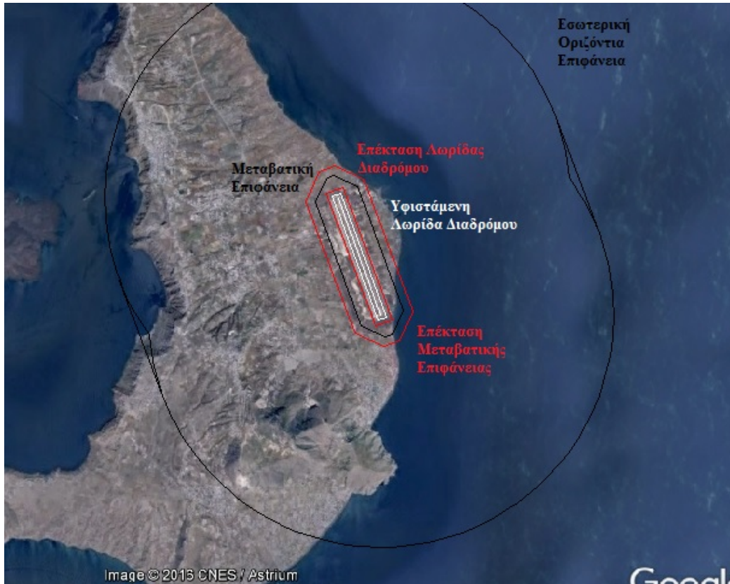
Εικόνα 4.13: Αεροδρόμιο Σαντορίνης με την υφιστάμενη λωρίδα διαδρόμου, τη μεταβατική επιφάνεια και τις απαιτούμενες επεκτάσεις τους
