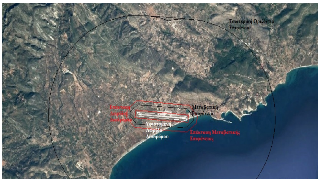
Εικόνα 4.17: Αεροδρόμιο Σάμου «Αρίσταρχος της Σάμου», με την υφιστάμενη λωρίδα διαδρόμου, τη μεταβατική επιφάνεια και τις απαιτούμενες επεκτάσεις τους
