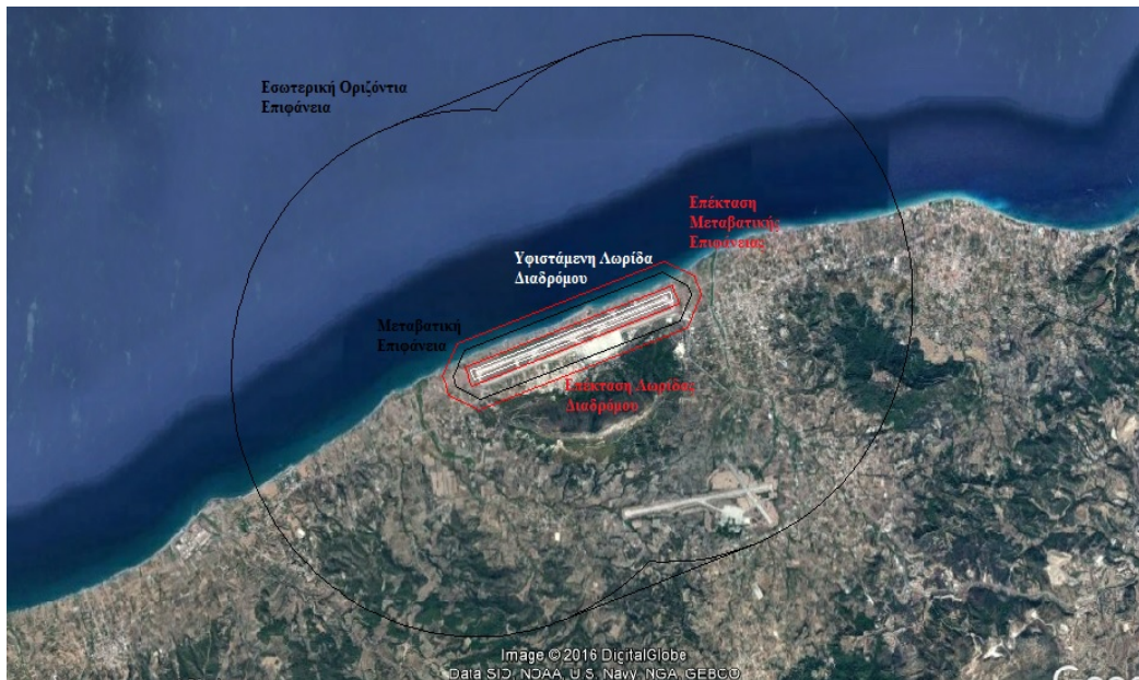
Εικόνα 4.12: Αεροδρόμιο Ρόδου «Διαγόρας», με την υφιστάμενη λωρίδα διαδρόμου, τη μεταβατική επιφάνεια και τις απαιτούμενες επεκτάσεις τους
