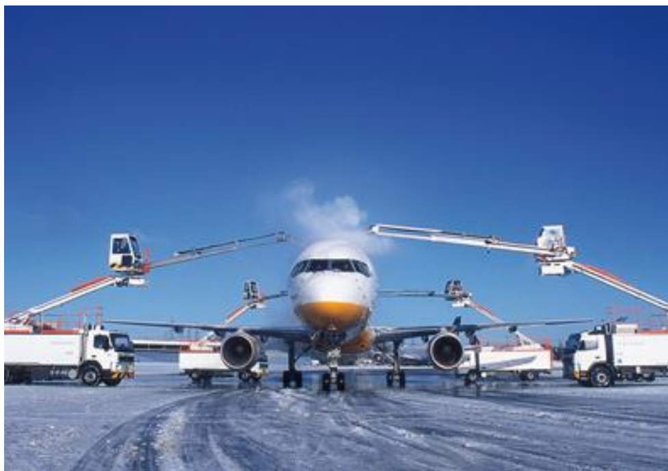
Εικόνα 3.35: Εφαρμογή του από-παγωτικού/ αντί-παγωτικού υγρού σε αεροσκάφος
