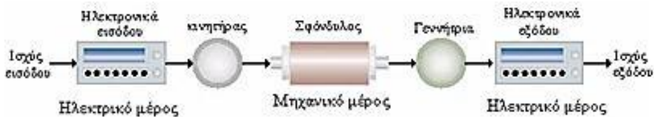
Εικόνα 5: Αρχή λειτουργίας του συστήματος Flywheel
