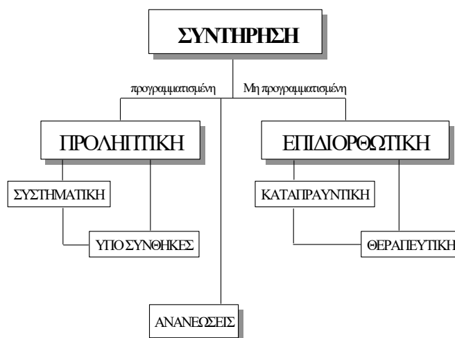
Εικόνα 1.2.: Γενικές αρχές συντήρησης σιδηροδρομικής
