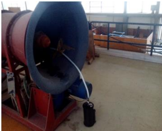
Εικόνα 3. 5: Ακροφύσιο τροφοδοτικού καπνού στην είσοδο της σήραγγας
