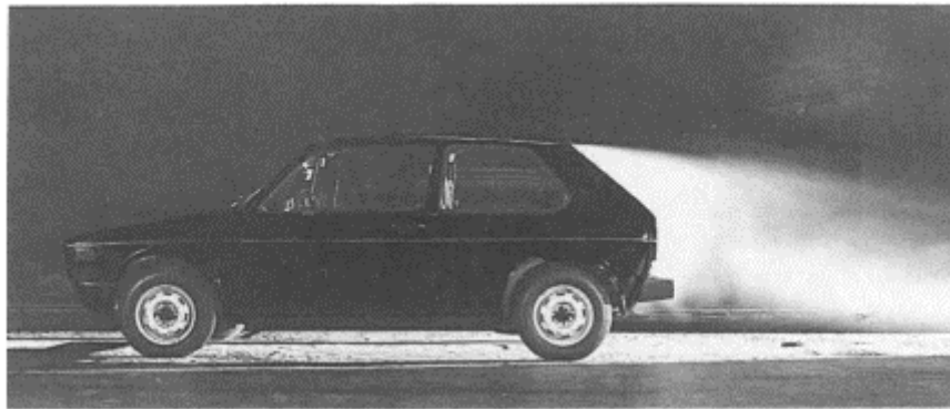
Εικόνα 1 20:Αποτύπωση με καπνό του ομόρρου σε ένα όχημα
