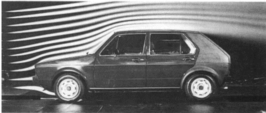
Εικόνα 1 19:Γραμμές ροής σε διαμήκη ημιτομή ενός VW Golf I σε όχημα κανονικών διαστάσεων σε σήραγγα
