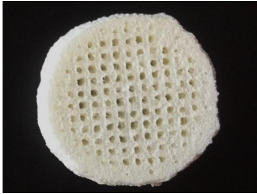
Εικόνα 7.4 αριστερά: ικρίωμα κολλαγόνου-υδροξυαπατίτη-ζελατίνης εκτυπωμένου με παραμέτρους F1800, Ex40, ονομαστικό πλάτος ίνας 800 μm, ονομαστικό ύψος στρώσεως 400μm, 9 στρώσεων, δεξιά: εικόνα από οπτικό μικροσκόπιο μεγέθυνσης x100, φίλτρο Brightfield.
