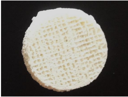
Εικόνα 7.1 αριστερά: ικρίωμα κολλαγόνου-υδροξυαπατίτη-ζελατίνης εκτυπωμένου με παραμέτρους F1800, Ex30, ονομαστικό πλάτος ίνας 600 μm, ονομαστικό ύψος στρώσεως 400μm, 9 στρώσεων δεξιά: εικόνα από οπτικό μικροσκόπιο μεγέθυνσης x100, φίλτρο Brightfield.
