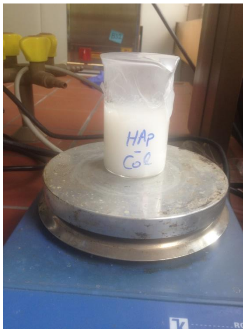
Εικόνα 4.3 αριστερά: πειραματική διάταξη διάλυσης του κολλαγόνου στο διάλυμα ορθοφωσφορικού οξέος, δεξιά: γήρανση του αιωρήματος υδροξυαπατίτη-κολλαγόνου-αργινίνης.
