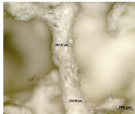
Εικόνα 7.3 αριστερά: ικρίωμα κολλαγόνου-υδροξυαπατίτη-ζελατίνης εκτυπωμένου με παραμέτρους F1800, Ex40, ονομαστικό πλάτος ίνας 700 μm, ονομαστικό ύψος στρώσεως 400μm, 9 στρώσεων, δεξιά: εικόνα από οπτικό μικροσκόπιο μεγέθυνσης x100, φίλτρο Brightfield.
