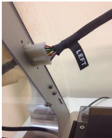
Εικόνα 5.4 αριστερά: βίσμα υψηλής ισχύος, δεξιά: βίσμα χαμηλής ισχύος.
