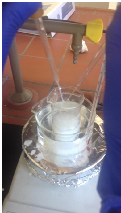
Εικόνα 4.2 αριστερά: σχηματισμός υδροξυαπατίτη, δεξιά: γήρανση του αιωρήματος υδροξυαπατίτη-χιτοζάνης-αργινίνης.
