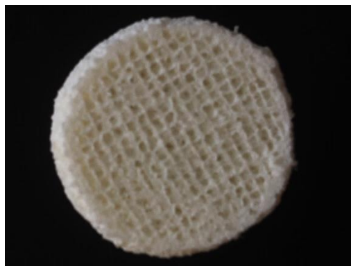
Εικόνα 7.5 αριστερά: ικρίωμα κολλαγόνου-υδροξυαπατίτη-ζελατίνης εκτυπωμένου με παραμέτρους F1800, Ex50, ονομαστικό πλάτος ίνας 800 μm, ονομαστικό ύψος στρώσεως 400μm, 9 στρώσεων, δεξιά: εικόνα από οπτικό μικροσκόπιο μεγέθυνσης x100, φίλτρο Brightfield.
