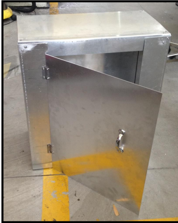
Εικόνα 38: Κατασκευή Πλαισίου στη Στράτζα
