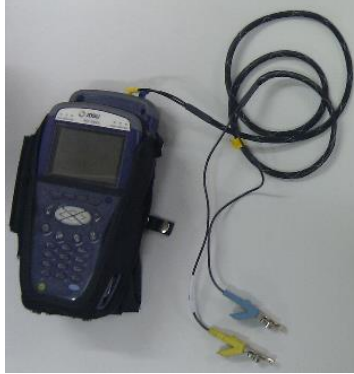
Εικόνα 3.4.1: Όργανο μέτρησης χαρακτηριστικών του μέσου διάδοσης JDSU HST-3000
