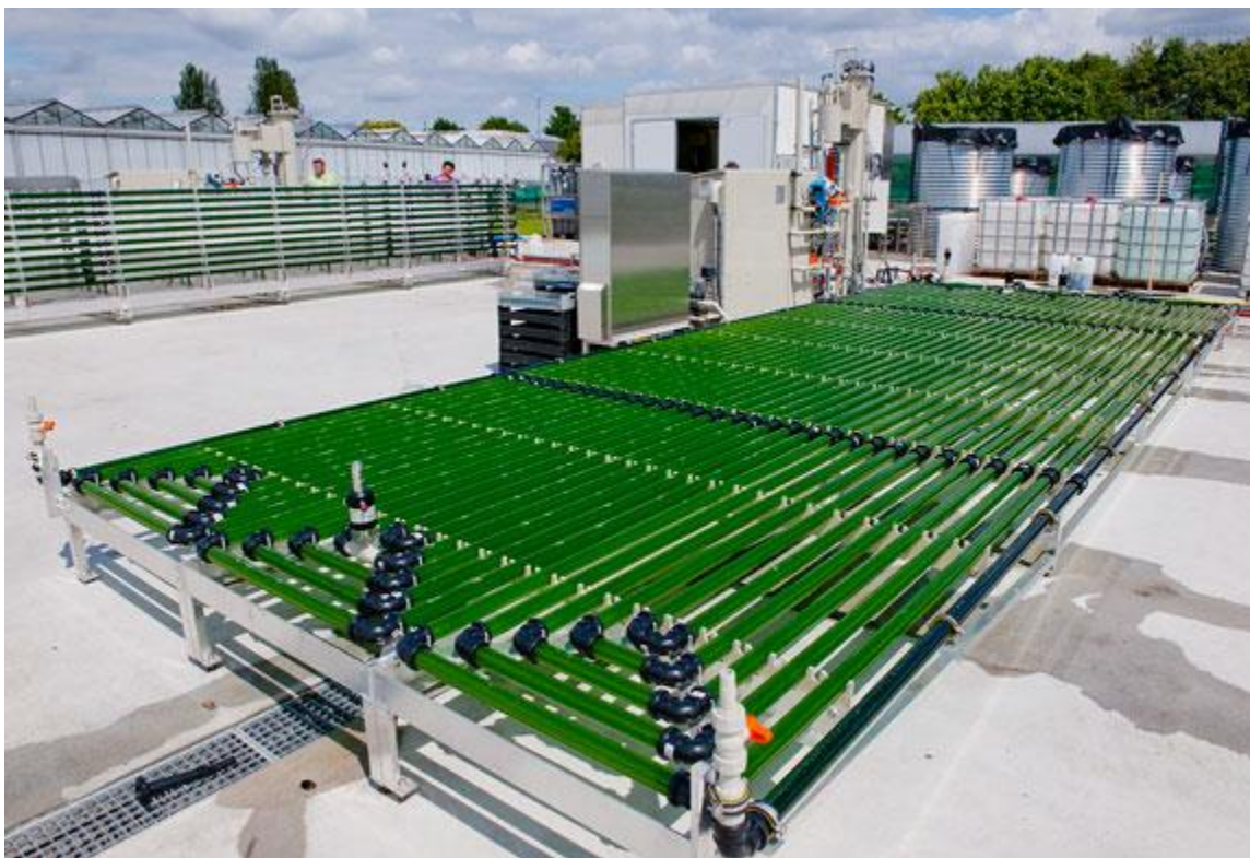
Εικόνα 2.4: Επίπεδοι κυλινδρικοί φωτοβιοαντιδραστήρες (Wageningen University) (18)
